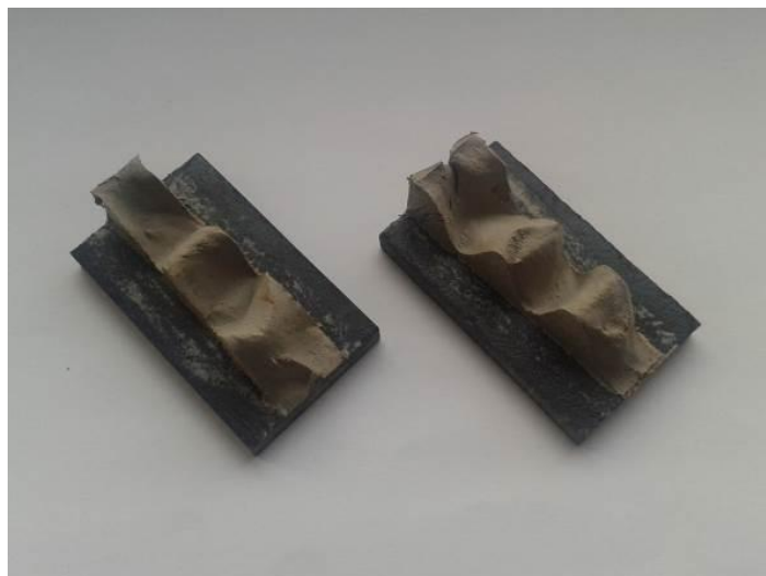
Slika 11. Uzorak SOUDASEAL 215LM nakon ispitivanja (Izvor: Liška i sur., 2015)
