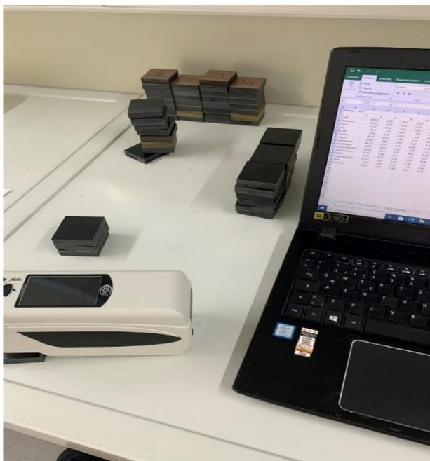
*Slika 20. Mjerenje promjene boje kolorimetrom*
