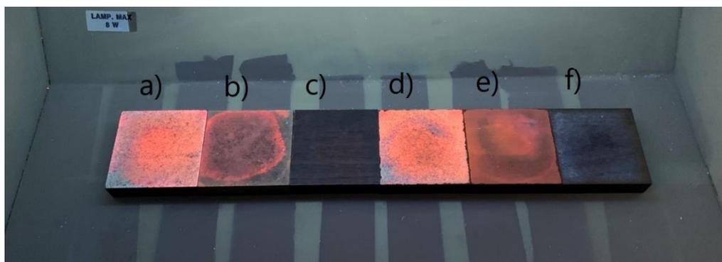
**Slika 35.** Uzorci Compact ploča s dekorom hrasta: a) uzorak tretiran nitratnom kiselinom 2 sata, b) uzorak tretiran sulfatnom kiselinom 2 sata, c) uzorak tretiran sanitarnom 24 sata, d) uzorak tretiran nitratnom kiselinom 24 sata, e) uzorak tretiran sulfatnom kiselinom 24 sata i f) uzorak tretiran solnom kiselinom 24 sata
