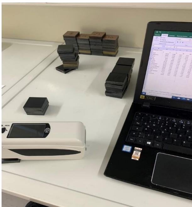
Slika 20. Mjerenje promjene boje kolorimetrom
