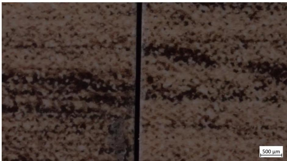
**Slika 32.** Usporedba površine ne tretiranog (lijevo) i uzorka tretiranog čajem (desno)
