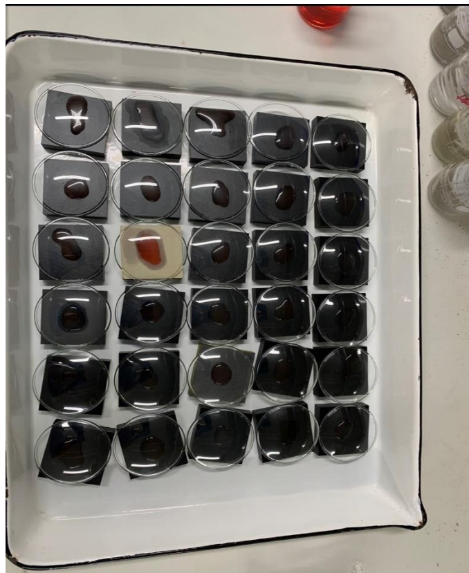
Slika 21. 10-minutni test tvrdoće površine otopinom klorovodične kiseline (4N)
