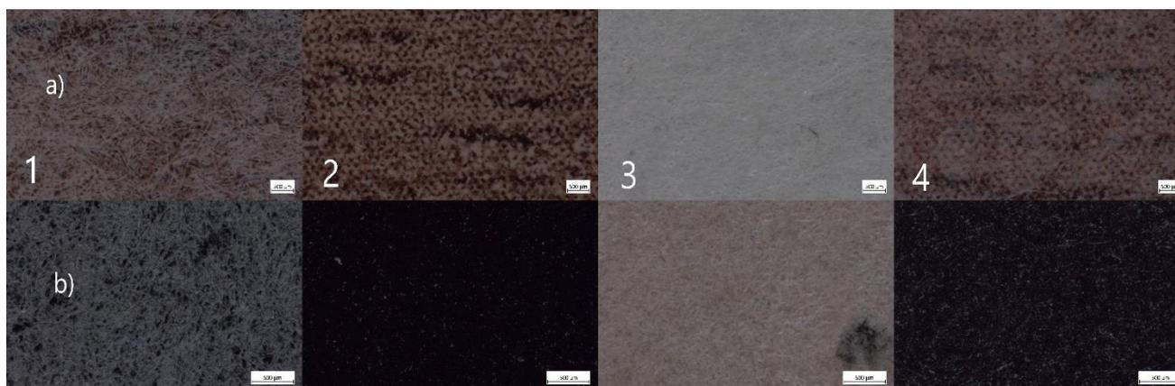
**Slika 31.** Usporedba površine tretiranih uzoraka Compact ploče kiselinom kroz 24 sata
