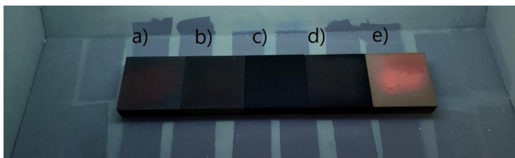
**Slika 36.** Uzorci Compact ploča s crnim dekorom: a) uzorak tretiran sulfatnom kiselinom 2 sata, b) uzorak tretiran nitratnom kiselinom 2 sata, c) uzorak tretiran čarlijem 24 sata, d) uzorak tretiran sulfatnom kiselinom 24 sata, e) uzorak tretiran nitratnom kiselinom 24 sata
