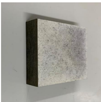
Slika 28. Izgled površine Compact ploča (dekor hrasta) tretiranog nitratnom kiselinom kroz 2 sata
