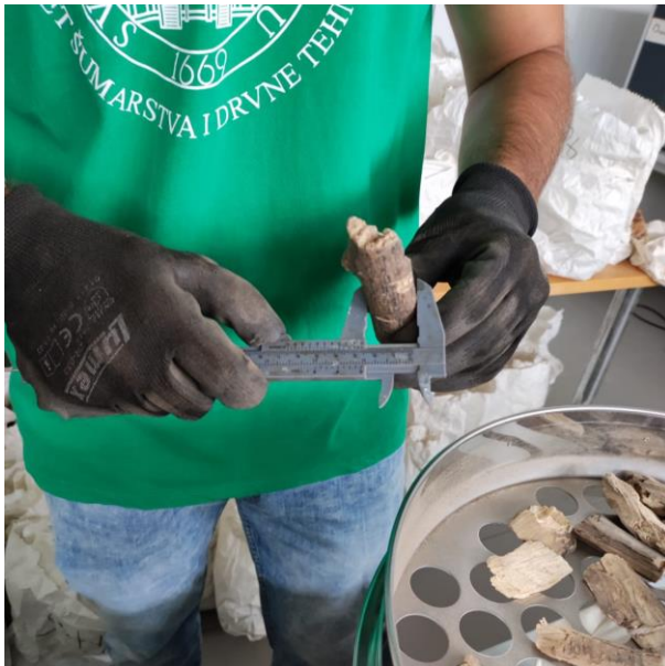
Slika 23. Izmjera srednjeg promjera
