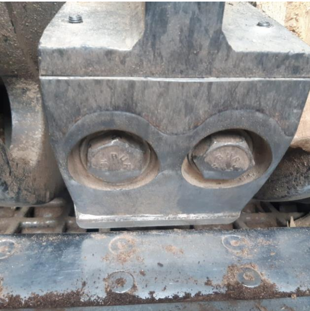
Slika 4. Nož i kontranož na bubanjskom iveraču
