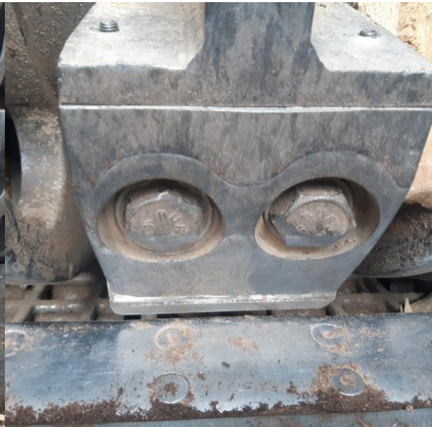
Slika 4. Nož i kontranož na bubanjskom iveraču
