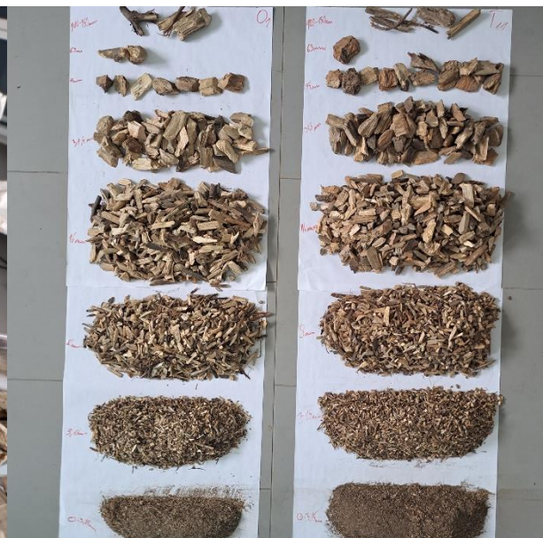
Slika 24. Uzorak drvene sječke prosijan na frakcije
