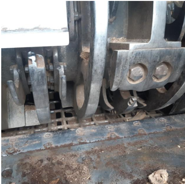
Slika 3. Kontranož na bubanjskom iveraču
