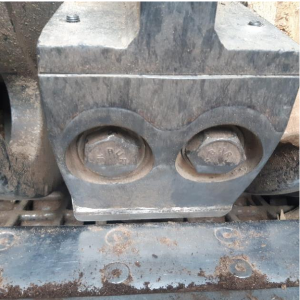
Slika 4. Nož i kontranož na bubanjskom iveraču
