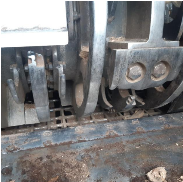
Slika 3. Kontranož na bubanjskom iveraču
