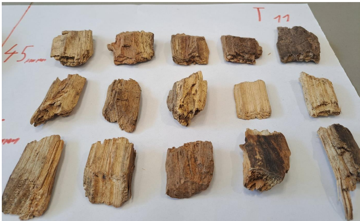
Slika 33. Uzorak T11 proizveden tupim noževima
