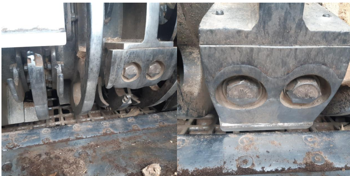
Slika 3. Kontranož na bubanjskom iveraču
