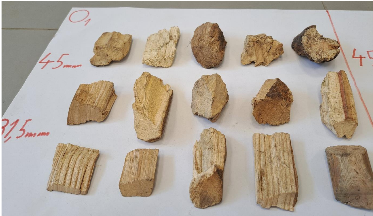
Slika 32. Uzorak O1 proizveden ostrim noževima
