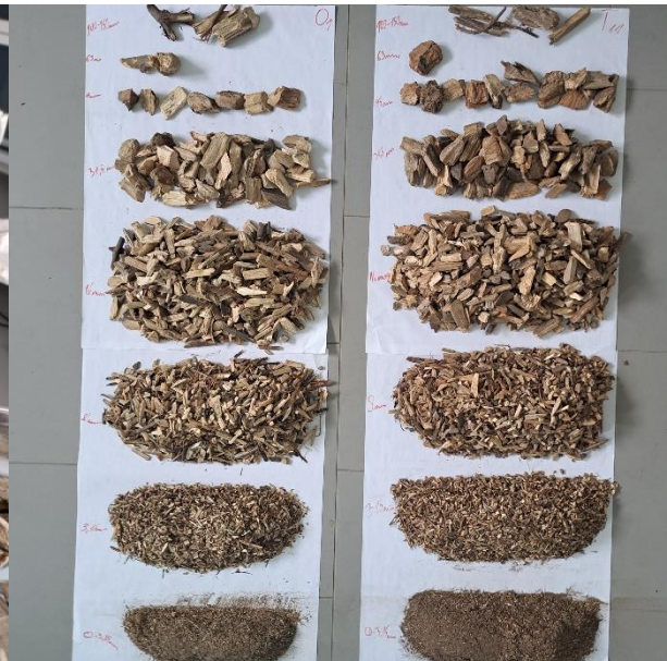
Slika 24. Uzorak drvene sječke prosijan na frakcije
