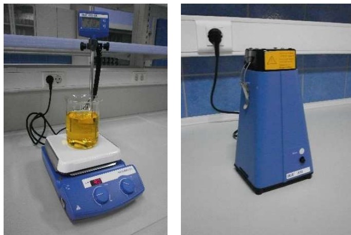
Slika 1. IKA C-MAG magnetna miješalica i analitički mlin A10 (Foto: Katalog opreme Šumarskog fakulteta, 2014)
