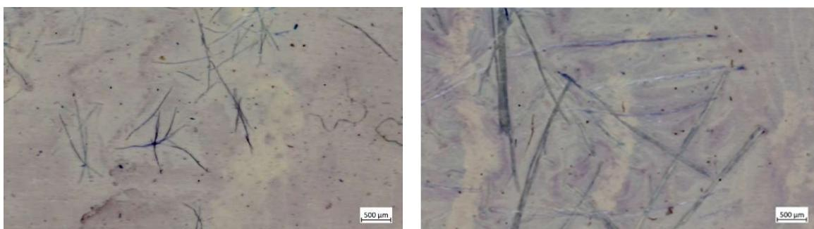
**Slika 18.** Mikroskopska snimka vlakanaca jele i trešnje
