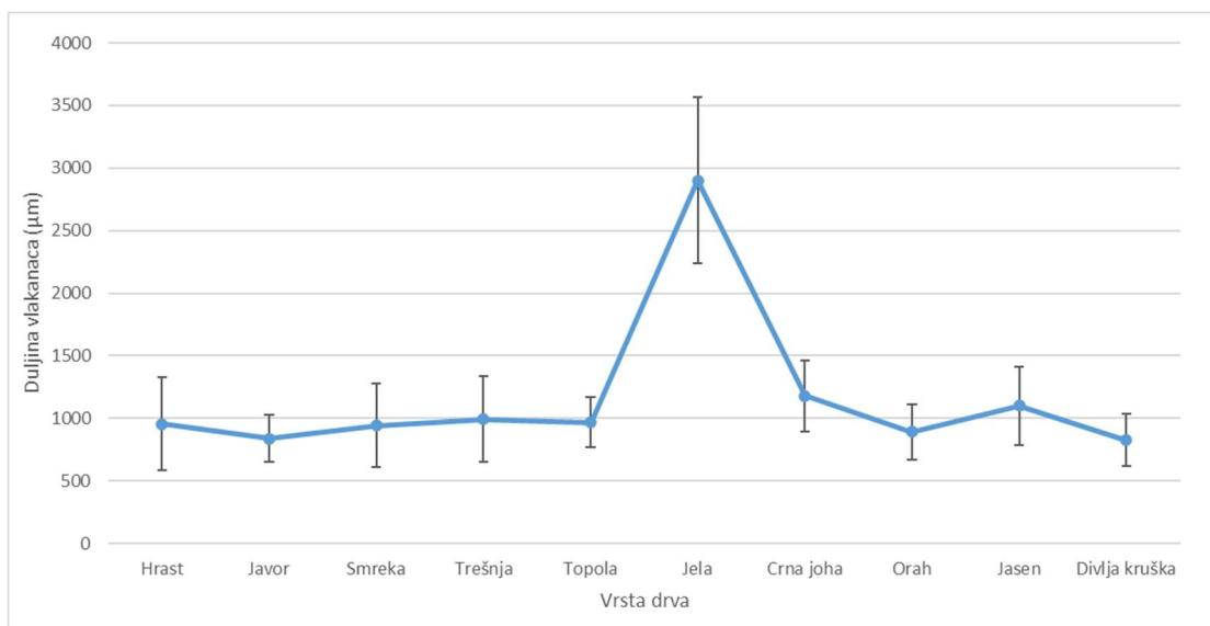
**Slika 17.** Prosječna duljina vlakanaca i standardna devijacija ( $\sigma$ )
