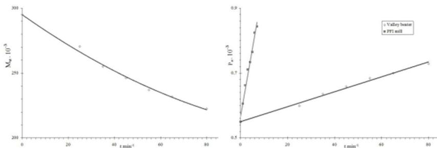
**Slika 5.** Promjene prosječne molekulske mase prilikom korištenja Valley mlina (lijevo); Ovisnost recipročnog stupnja polimerizacije o vremenu rafinacije celuloze korištenjem Valley mlina (desno)
