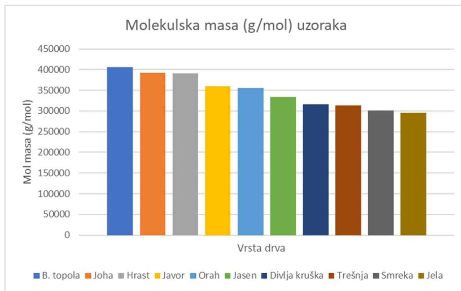
**Slika 21.** Srednje vrijednosti molekulske mase delignificiranih drvnih vlakana
