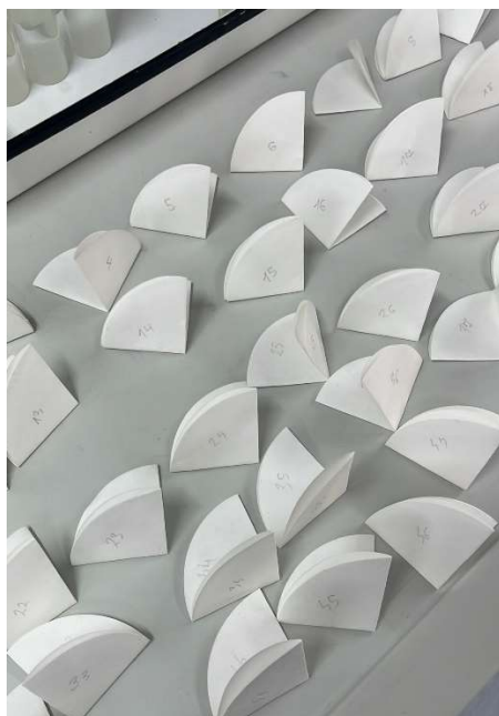
Slika 8. Priprema filter papira za umetanje u Büchnerov lijevak
