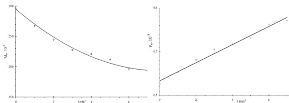
**Slika 4.** Promjene prosječne molekulske mase prilikom korištenja PFI mlina (lijevo); Ovisnost recipročnog stupnja polimerizacije o vremenu rafinacije celuloze korištenjem PFI mlina (desno)
