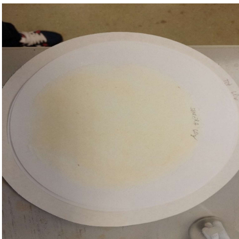
Slika 23. Eksperimentalni papir izrađen iz vlakana uzorka Smreka I
