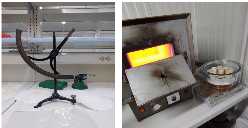
Slika 20. Uređaj (vaga) za mjerenje gramature (lijevo) i Muffolna peć za žarenje (desno)
