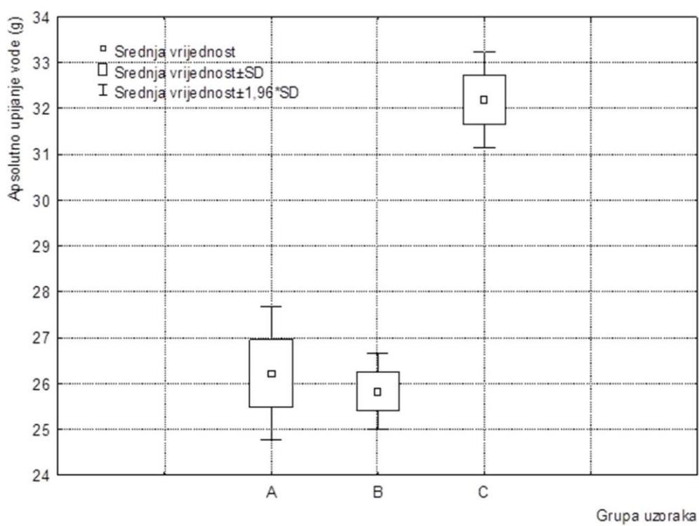
**Slika 14.** Grafički prikaz absolutnog upijanja vode pojedinih grupa uzoraka ispitanih ploča
