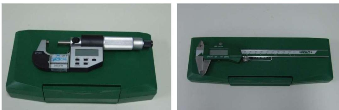
*Slika 8. Digitalni mikrometar i pomično mjerilo (Foto: Maleta, 2011.)*
