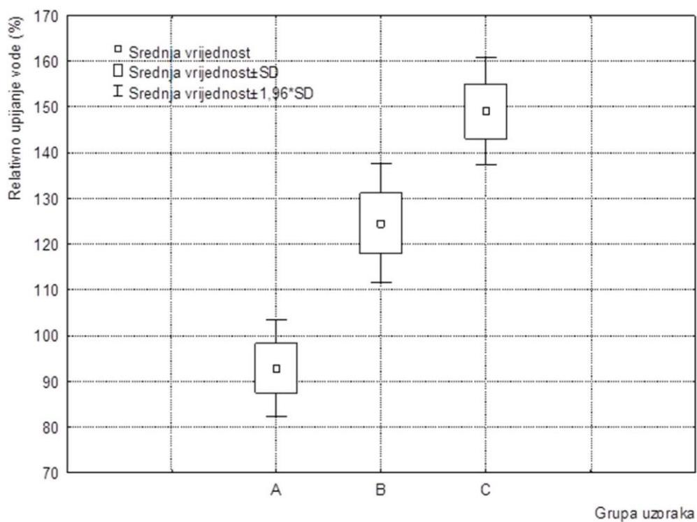
**Slika 15.** Grafički prikaz relativnog upijanja vode pojedinih grupa uzorka ispitanih ploča
