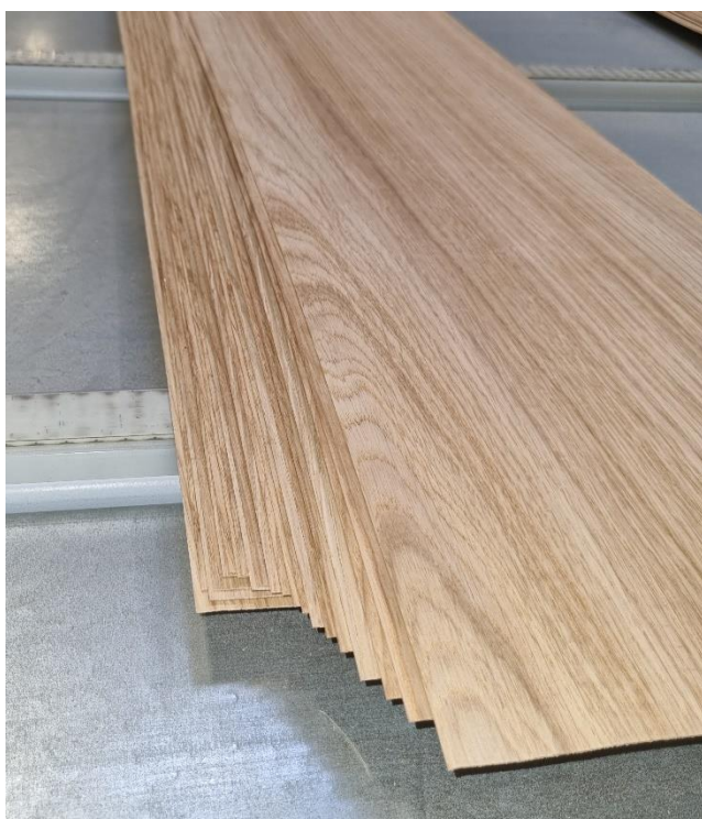
Slika 16b. Paket sa razmaknutim listovima
