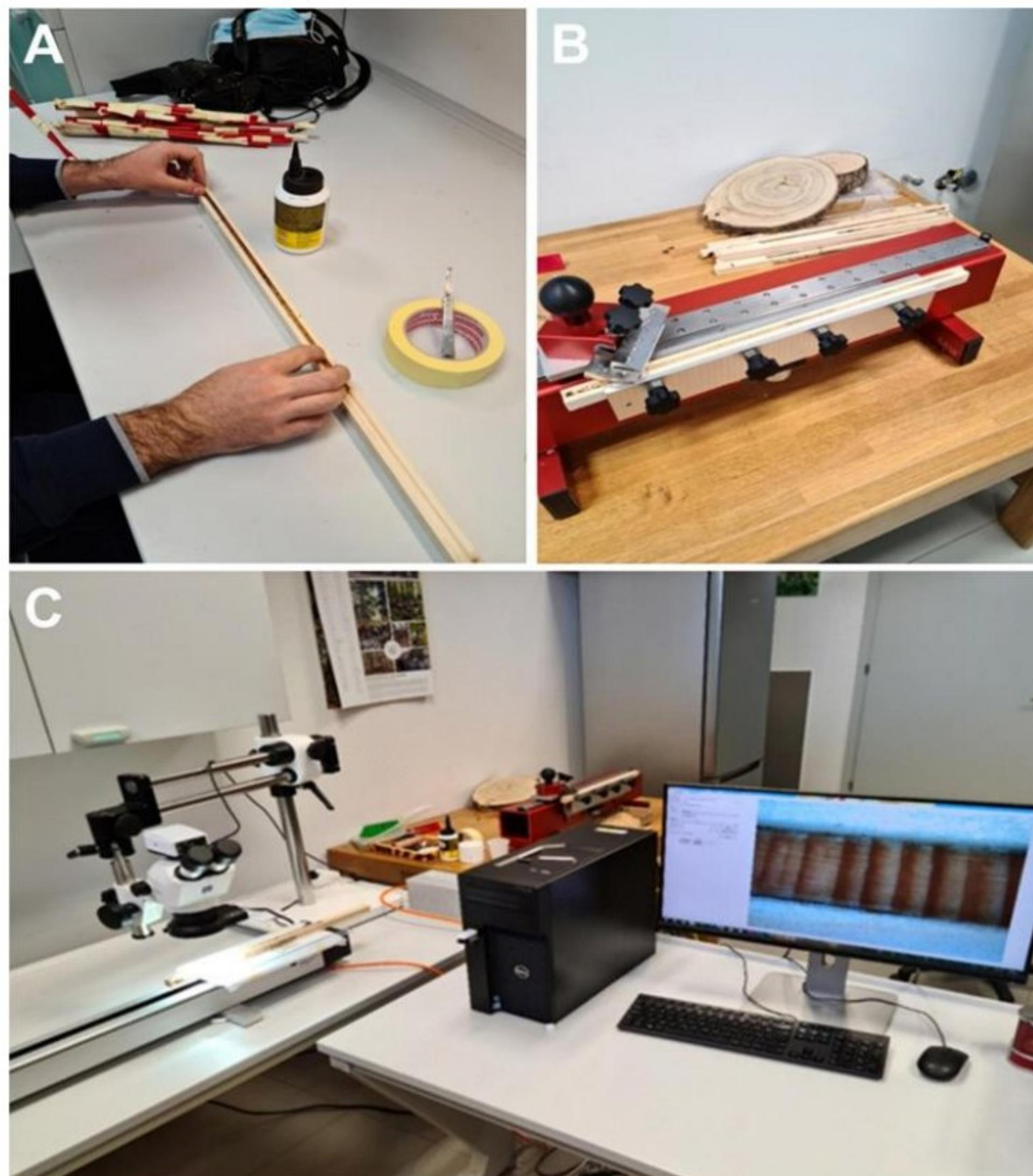
**Slika 5.** Postupak pripreme uzoraka (lijepanje A, mehanička priprema B i skeniranje C)
