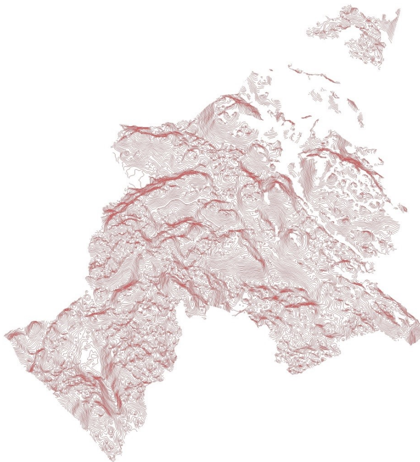
Slika 29 Digitalni model reljefa istraživanog područja (tri gospodarske jedinice) – 3D prikaz slojnicama (Izvor: Pernar, R. i dr., 2020: „Važnost daljinskih istraživanja pri procjeni šteta na šumskim sastojinama uzrokovanih velikim prirodnim nepogodama“)
