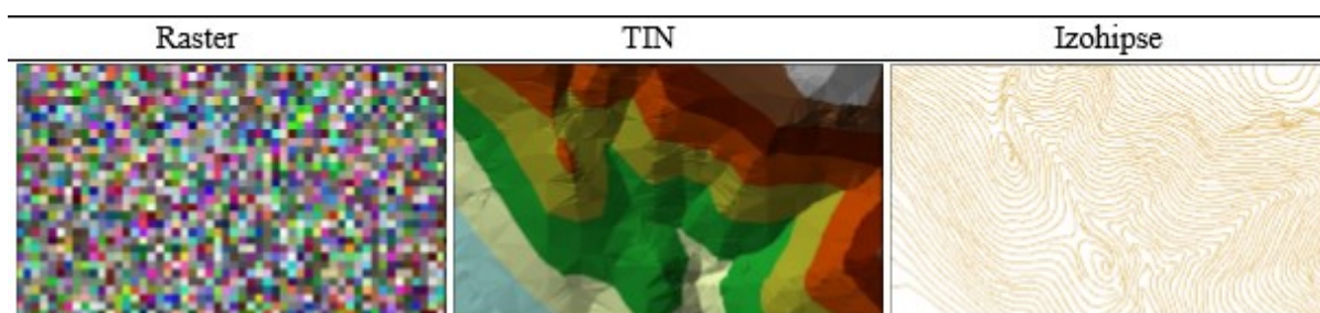
Slika 8 Osnovne strukture za predstavljanje površina u digitalnom obliku (Izvor: Šiljeg, A., 2013)
