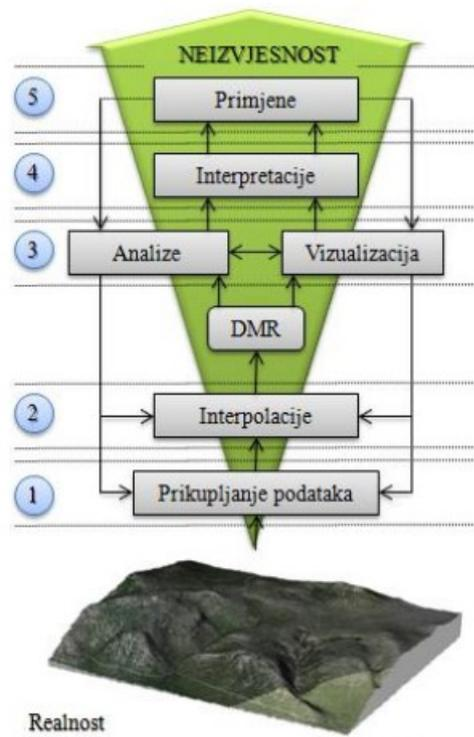
Slika 10 Faze digitalnog modeliranja reljefa
