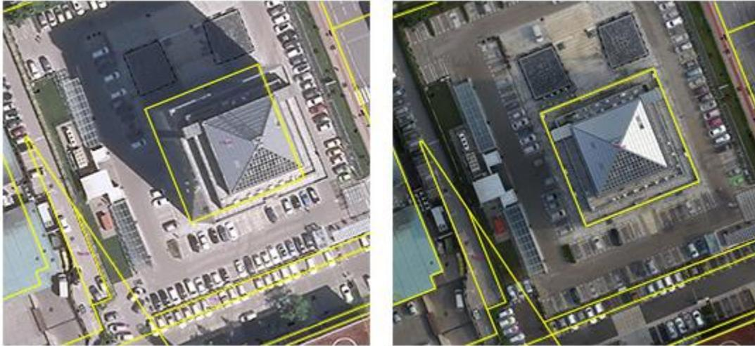
Slika 3. Primjer običnog ortofota (lijevo) i pravog ortofota (desno)
