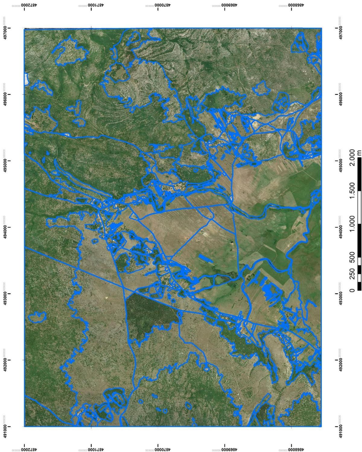
Slika 33. Karta sa prikazom izdvojenih poligona načina korištenja zemljišta po CORINE klasifikaciji na podlozi DOF-a nastaloj od satelitske snimke preuzete sa Google Earth-a
