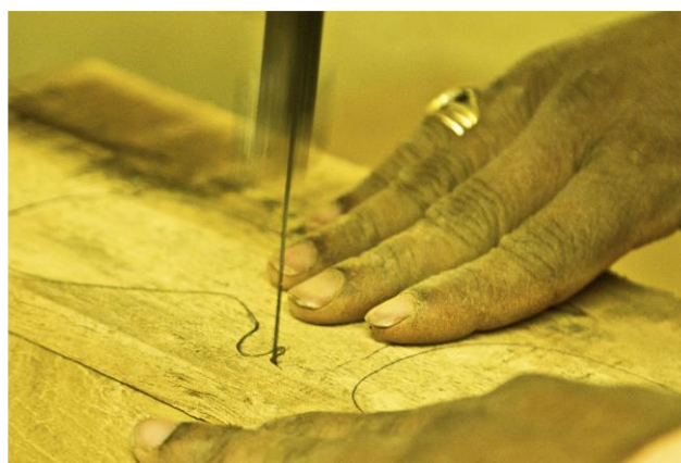
Slika 12. Automatizirani tanki list pile koriste se za rezanje drvenih daski (Bibhudutta Baral i dr., 2016)
