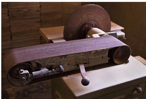
Slika 10. Stroj za brušenje (Bibhudutta Baral i dr., 2016)
