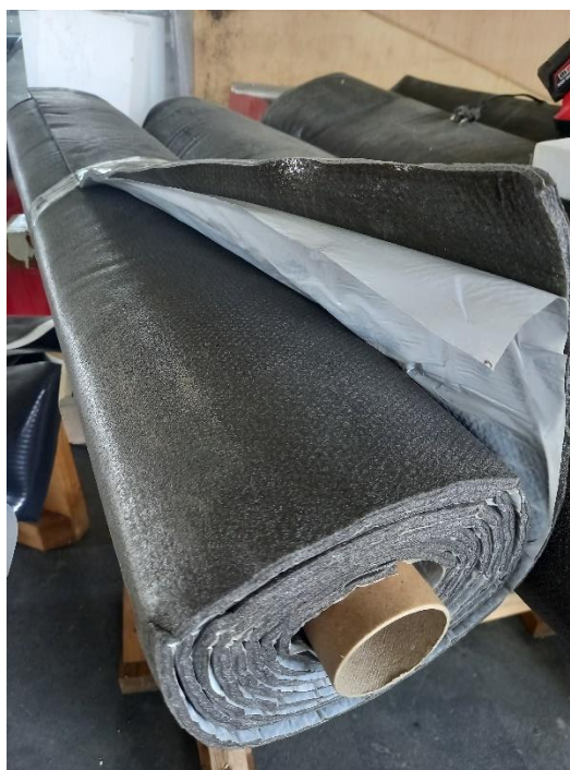
Slika 20: Spužvasti polietilen sa olovnom pločom
