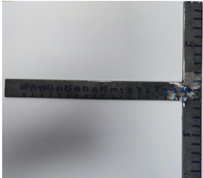
Slika 11. Priručni alat s mjernom skalom za određivanje mjernog mjesta na određenoj udaljenosti od usisne cijevi
