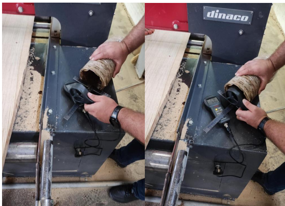
Slika 13. Prikaz mjerenja brzine strujanja zraka a) na udaljenosti 0,75*d i b) na udaljenosti 0*d
