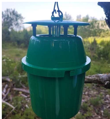
Slika 9: WitaTrap klopka sa neprozirnim spremnikom
