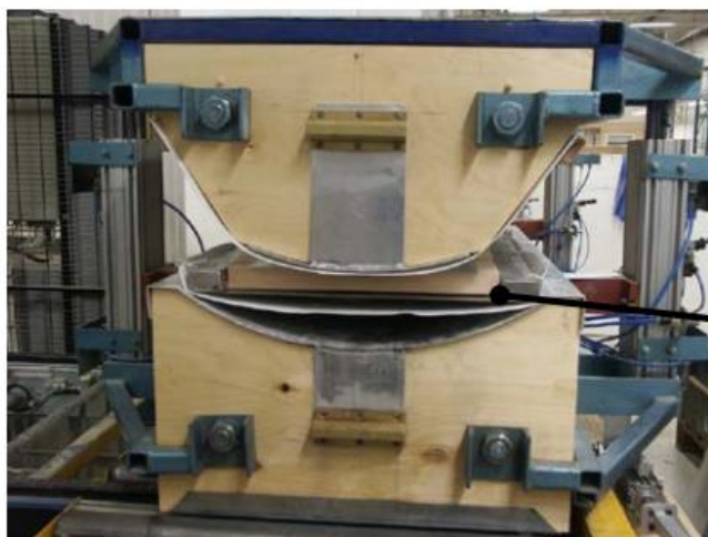
Slika 29. Drvni element u preši prije početka savijanja (Sandberg i Johansson,2005)
