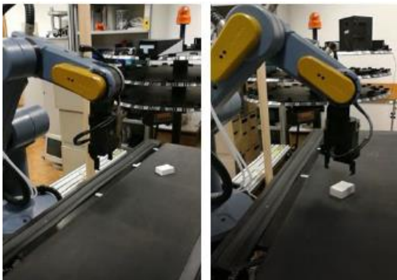
Slika 3. Prikaz eksperimentalne robotske ruke upravljane mikroročunalom Raspberry Pi, pomoću sustava strojnog vida, u procesu automatskog sortiranja na trakastom transporteru (Costa i dr., 2019)
