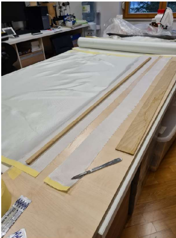
Slika 9a. Priprema staklenih vlakana
