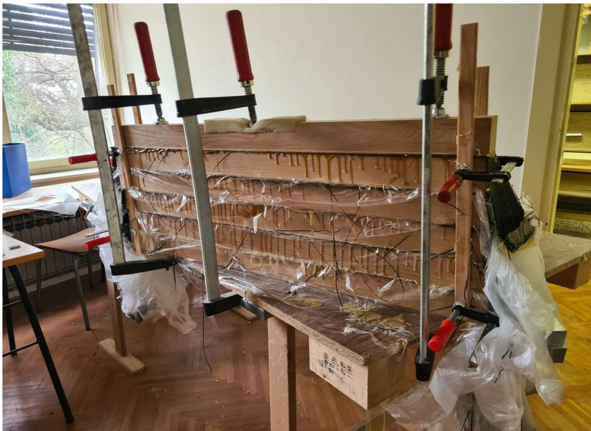
Slika 10. Završno lijepljenje ojačanja i elemenata
