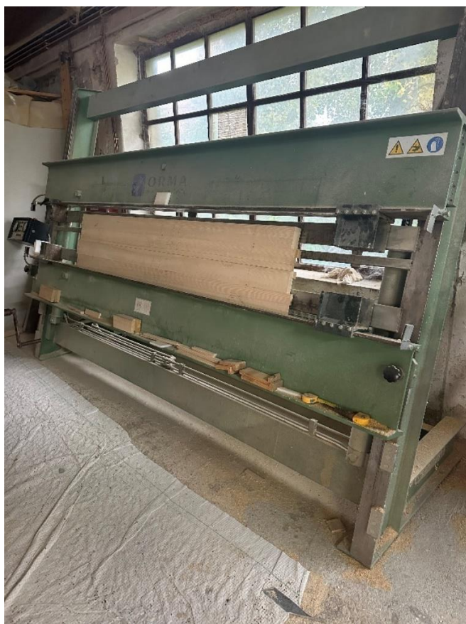
Slika 5: Lamelirani elementi u preši
