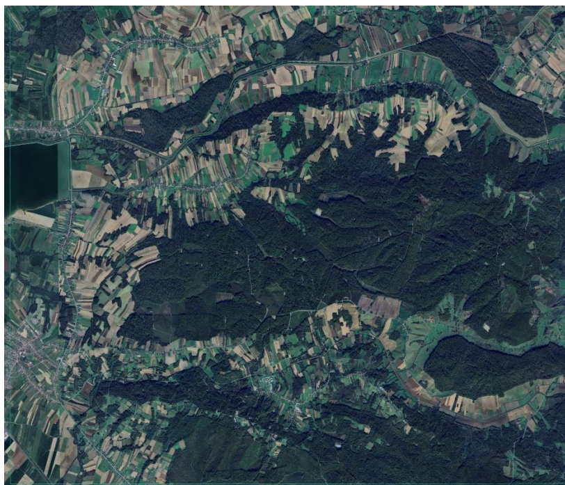
Slika 9. Fotomozaik dobiven postupkom spajanja niza fotografija u programu Microsoft ICE
