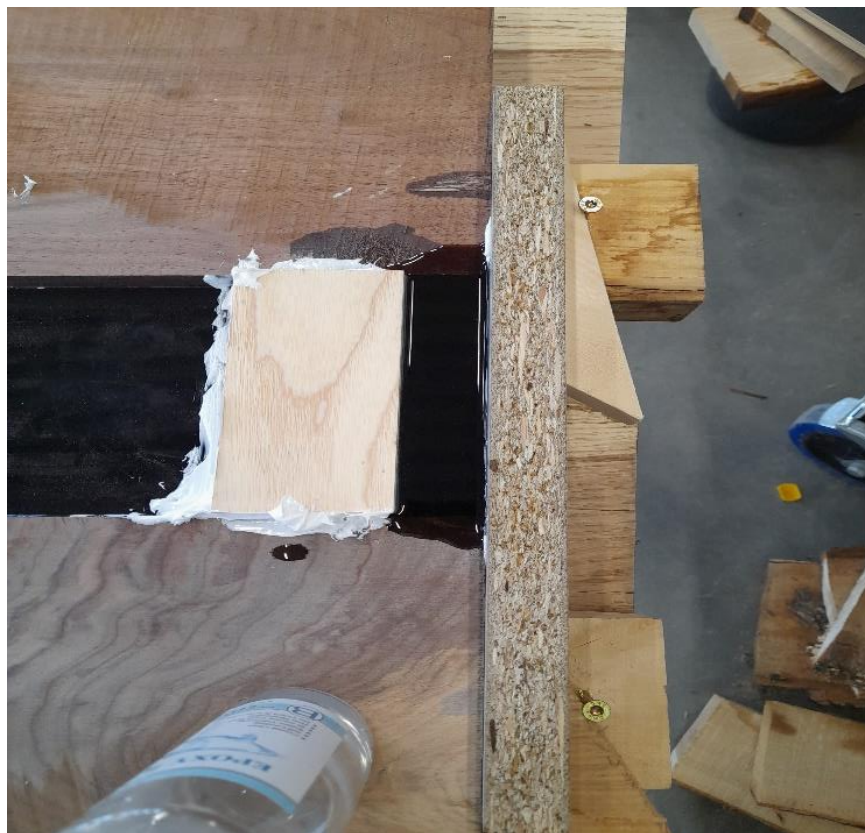
Slika 13. Popravljanje rubova s epoksidnom smolom
