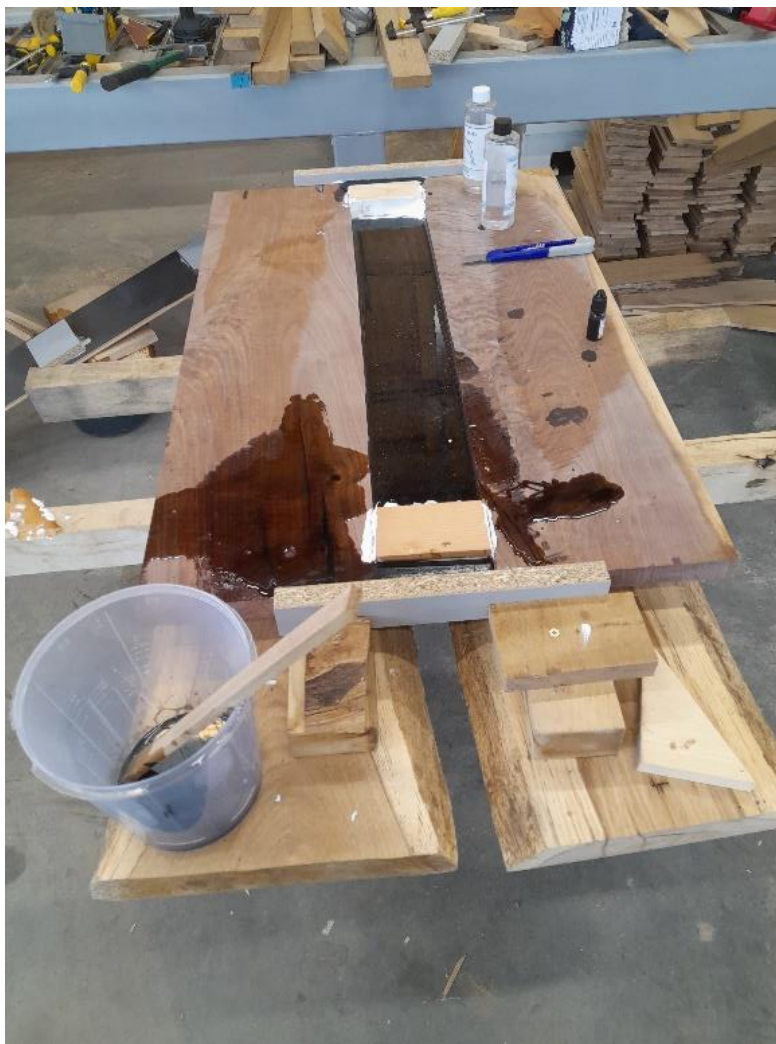
Slika 12. Izlivanje epoksidne smole u kalup
