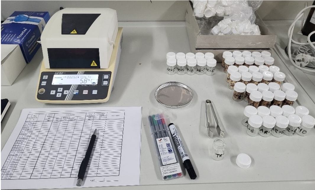
Slika 26. Oprema potrebna za ispitivanje halogenim vlagomjerom (foto:Ivanda A., 2024.)
