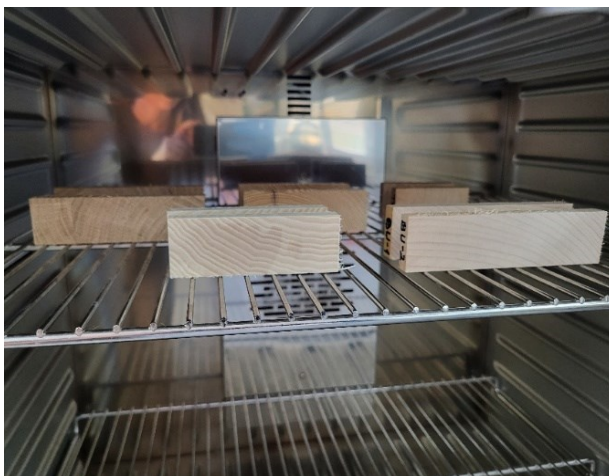
Slika 23. Uzorci "štangica" u sušioniku (foto:Ivanda A., 2024.)
