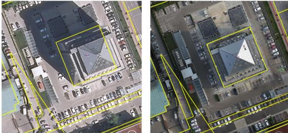
Slika 5. Razlika između ortofota i pravog ortofota
