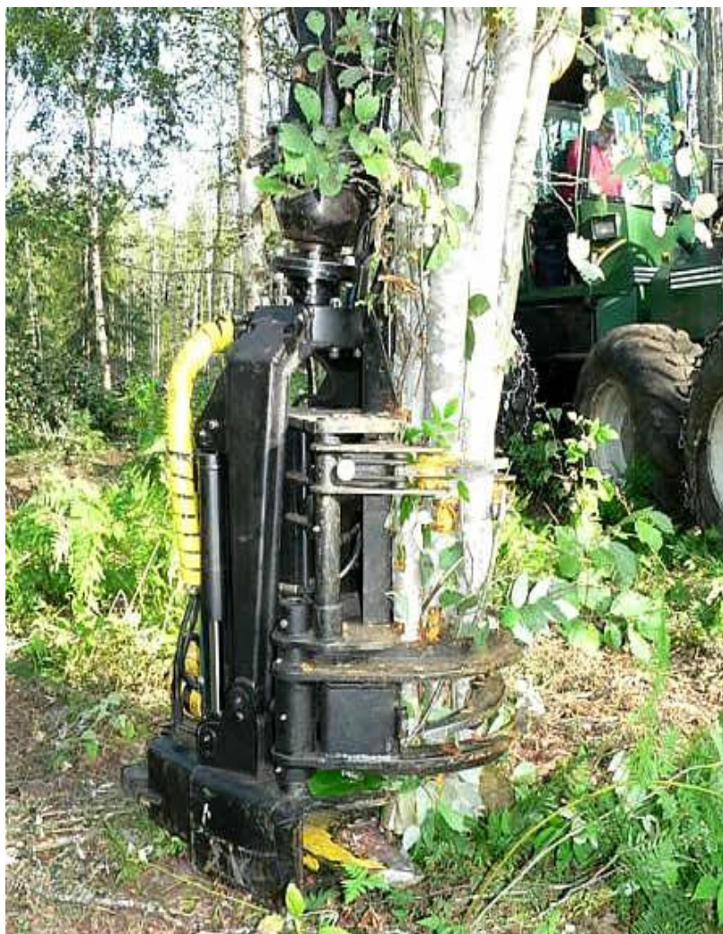
Slika 15. Harvesterska glava za pridobivanje energijskog drva
