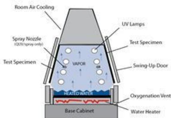
Slika 5. Položaj UV lampi i uzoraka u QUV uređaju (Q-LAB, 2016)
