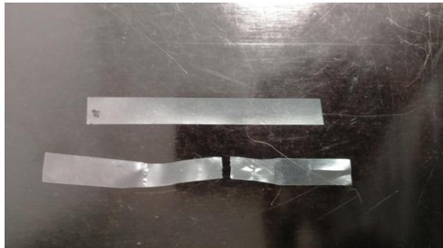
Slika 16. Izgled uzorka prije i poslije ispitivanja
