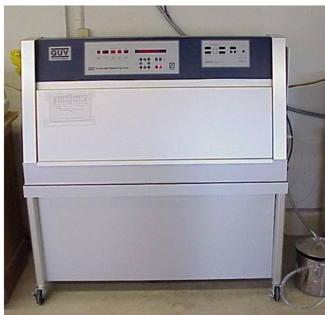
Slika 4. QUV uređaj za ubrzano izlaganje
