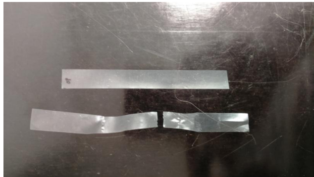
Slika 16. Izgled uzorka prije i poslije ispitivanja
