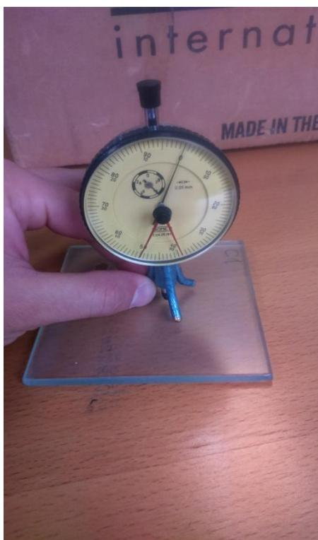
Slika 10. Mjerenje debljine suhog filma pomoću komparatora
