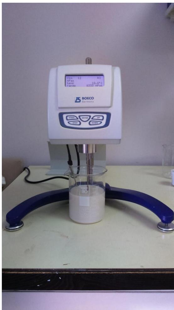
Slika 6. Rotacijski viskozimetar
