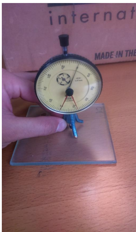
Slika 10. Mjerenje debljine suhog filma pomoću komparatora
