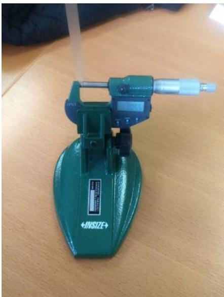
Slika 11. Mjerenje debljine suhog filma pomoću mikrometra
