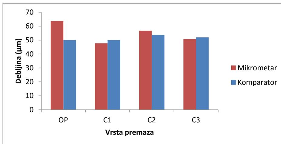
Slika 30. Debljina suhog filma mjerena mikrometrom i komparatorom
