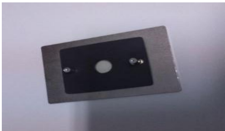
Slika 21. Shimadzu 8400S spektrofotometar (a) i uzorak slobodnog filma pripremljen za mjerenje (b)
