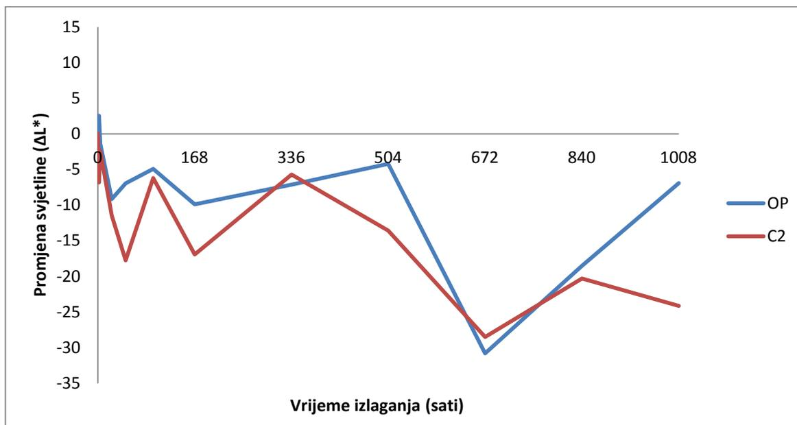
Slika 33. Prikaz promjena svjetline ( $\Delta L^*$ ) na sustavima premaza OP i C2
