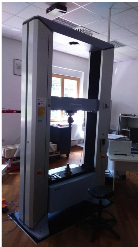
Slika 14. Univerzalni uređaj za ispitivanje mehaničkih svojstava
