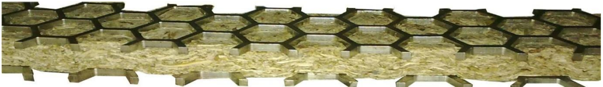
Slika 4: Utisnuta čelična matrica na ploču
