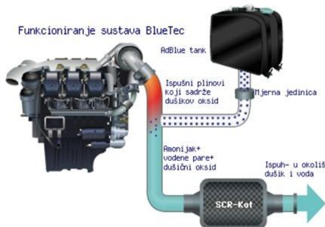
Slika 11. BlueTec tehnologija obrade ispušnih plinova
