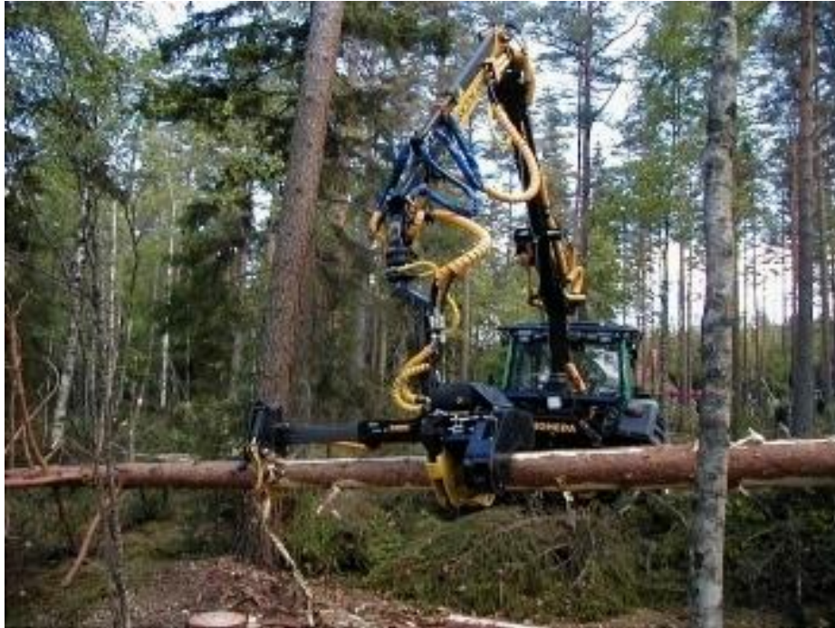
Slika 4. Harvesterska glava s taktnom tehnologijom (Izvor: Uusitalo 2010).
