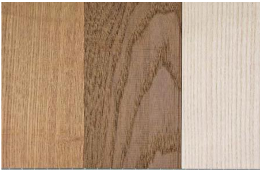
Slika 3. Prirodna jasenovina (desno) i toplinski modificirana jasenovina pri različitim temperaturama (lijevo i u sredini) (Jirouš Rajković i sur.,2007)
