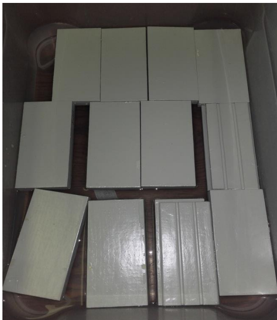
Slika 14. Uzorci postavljeni u vodu licem prema dolje
