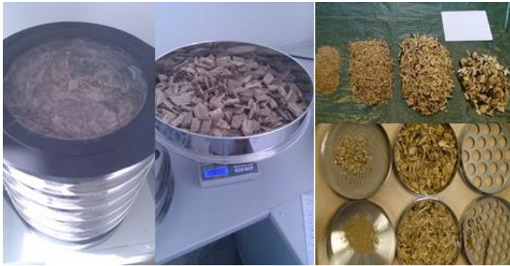
Slika 35. Granulometrijska metoda kod drvene sječke
