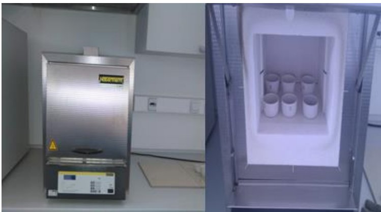
Slika 27. Peć za žarenje Nabertherm L9/11
