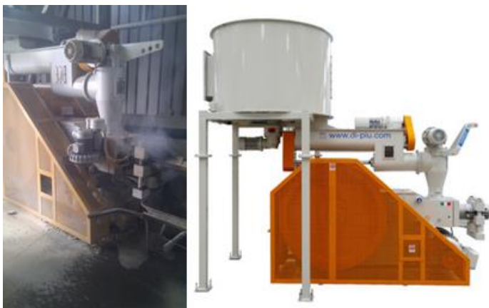
Slika 20. Briketirница DI PIU' MB70
