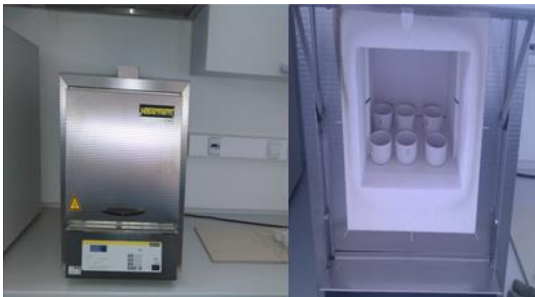
Slika 27. Peć za žarenje Nabertherm L9/11
