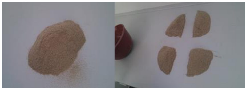
Slika 38. Uzorkovanje dobivenog samljevenog proizvoda
