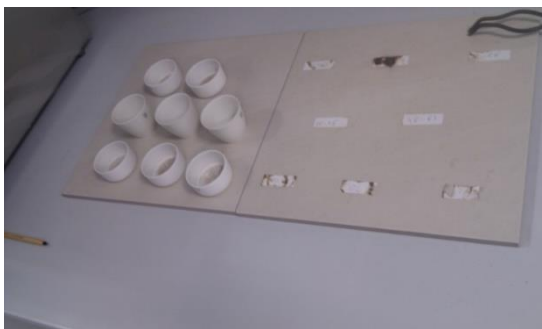
Slika 40. Posudice nakon žarenja na ploči
