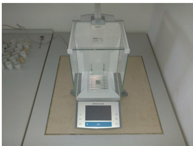
Slika 31. Analitička digitalna vaga Mettler Toledo XA 204 DR
