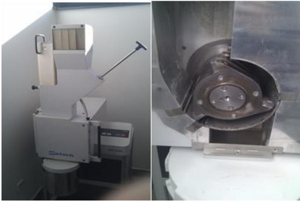
Slika 26. Rezni stroj Retch SM 300
