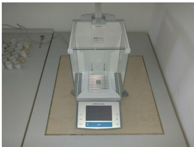
Slika 31. Analitička digitalna vaga Mettler Toledo XA 204 DR
