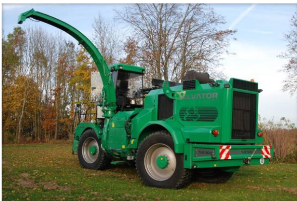
Slika 11. Iverač Silvator Diamant 2000 koji se koristi za usitnjavanje u pogonu
