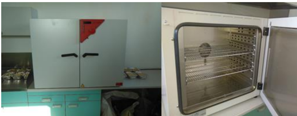
Slika 36. Sušionik Binder FD 115
