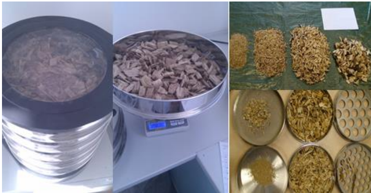
Slika 35. Granulometrijska metoda kod drvene sječke
