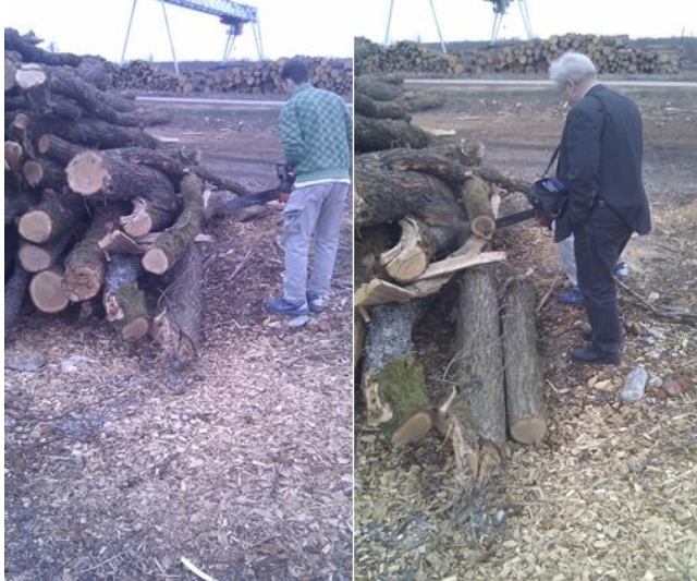
Slika 24. Uzorkovanje kolotova hrasta lužnjaka
