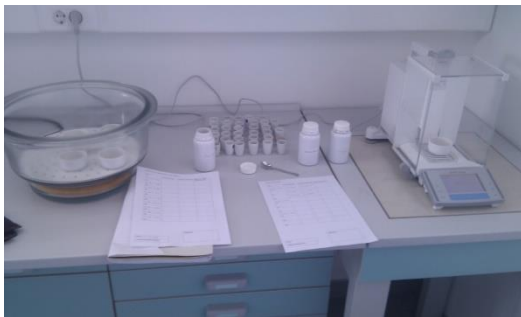
Slika 41. Postupak kod vaganja posudice
