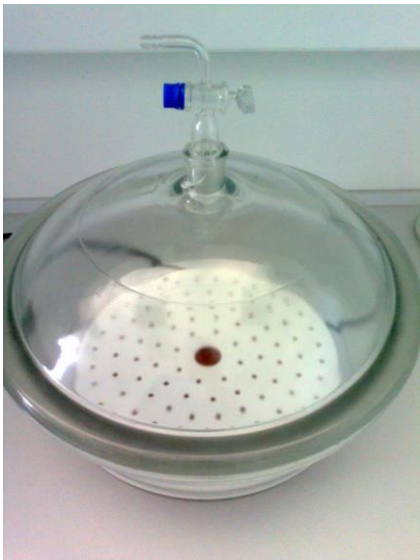
Slika 29. Eksikator za hlađenje zagrijanih uzoraka
