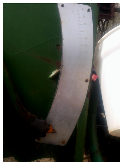
Slika 19. Poluga za namještanje propusnosti sjemena sijal'ice
