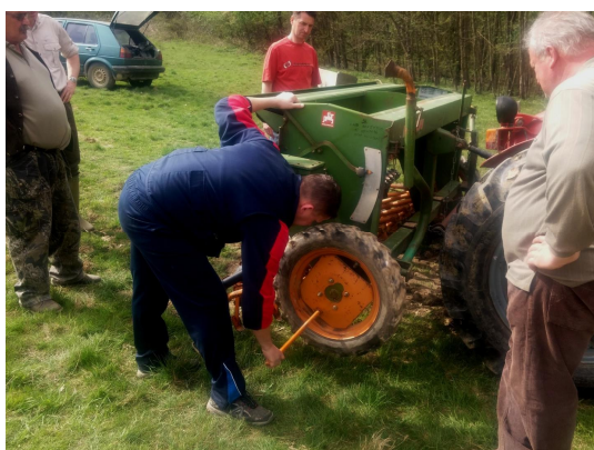
Slika 18. Provjera propusnosti sijal'ice na zadanu površinu
