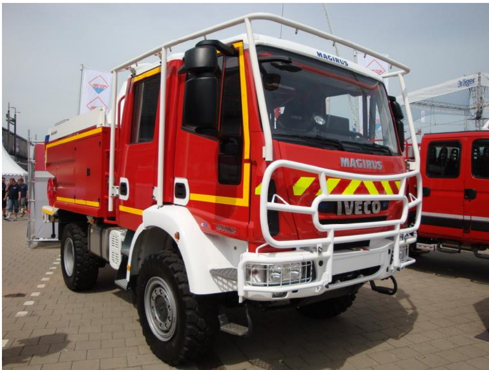
Slika 6. Zaštita kabine vatrogasnoga vozila
