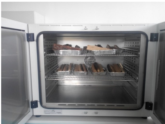
Slika 43. Utvrđivanje udjela vode metodom sušionika
