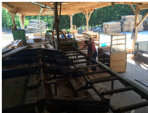
Slika 19. Odvozne rampe sa separatorima
