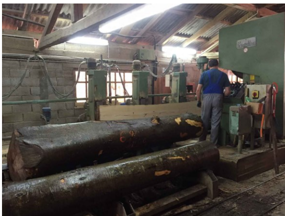
Slika 16. Kolica i pila Primultini 1300
