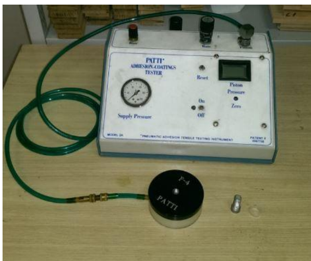
Slika 22. Instrument za određivanje adhezije metodom otkidanja valjčića
