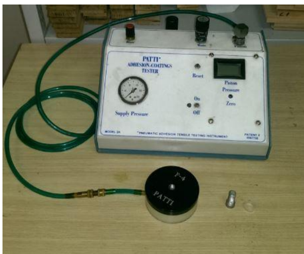
Slika 22. Instrument za određivanje adhezije metodom otkidanja valjčića
