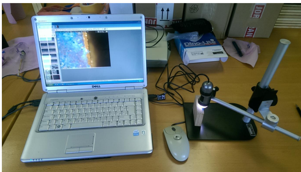
Slika 23. Određivanje debljine filma laka digitalnom kamerom
