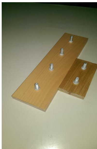
Slika 21. Prikaz zalijepljenih valjčića prilikom određivanja adhezije
