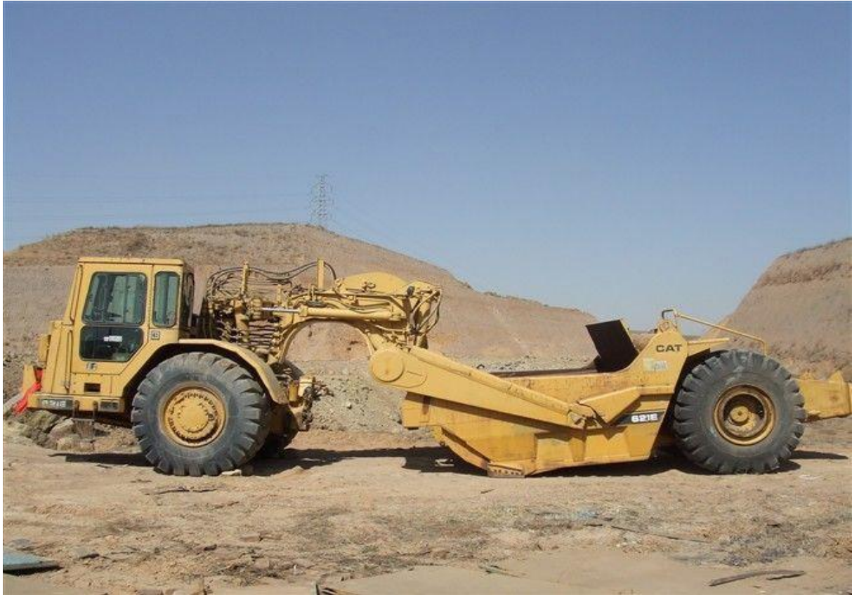
Slika 6. Skrejper - Caterpillar 621E
