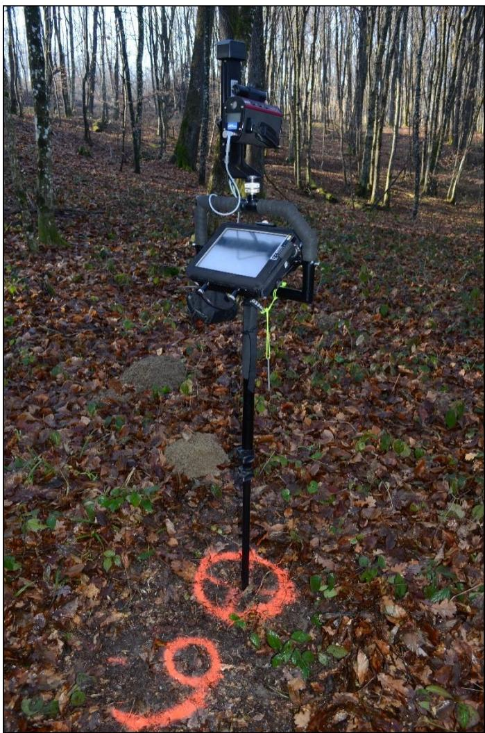
Slika 15. Prikaz izmjere korištenjem Field-Map uređaja.
