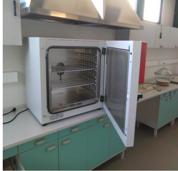
Slika 24. Sušionik BINDER FD 115
