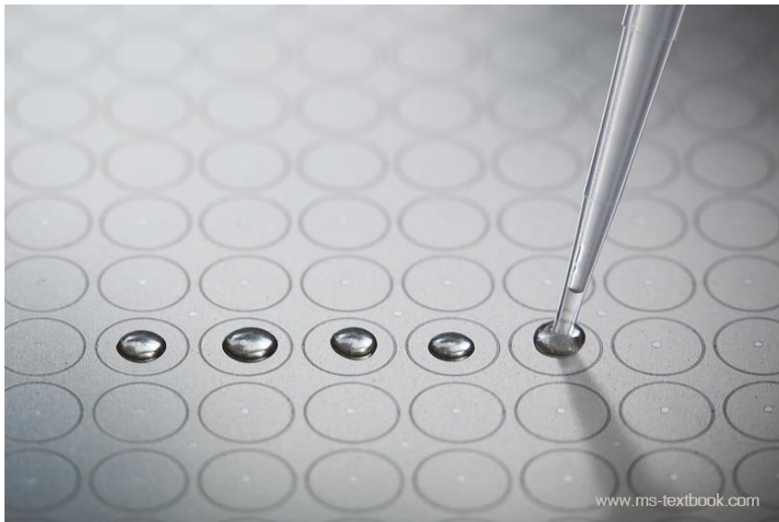
Slika 18 Polirane čelične mete koje se koriste u masenoj spektrometriji
