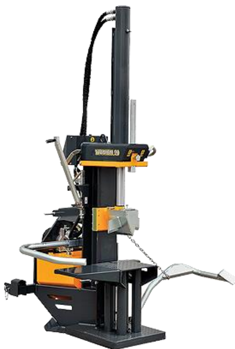
Slika 17. Hidraulični cjepač (pogon preko traktora) Izvor: http://uniforest.si/proizvodi/cepilniki/60/kardan_cd/
