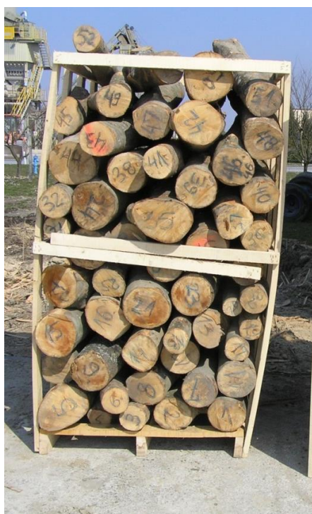
Slika 33. Složaj palete oblice metrice za mjerenje u vlažnom stanju (lijevo) i prosušenom stanju (desno)
