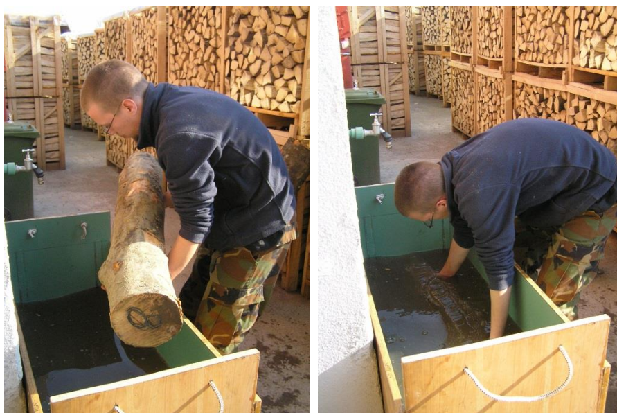
Slika 36. Mjerenje volumena oblice volumetrijskom metodom uranjanjem u kadu
