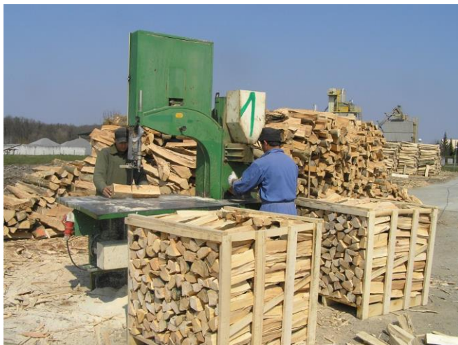
Slika 21. Prekrajanje metrice tračnom pilom na zadanu duljinu i slaganje u paletu (lijevo), složena paleta kratkih cjepanica (desno)
