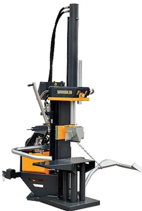
Slika 17. Hidraulični cjepač (pogon preko traktora) Izvor: http://uniforest.si/proizvodi/cepilniki/60/kardan_cd/
