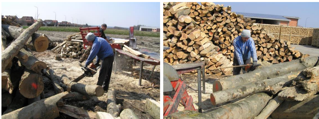
Slika 31. Prikračivanje oble višemetrice motornom lančanom pilom
