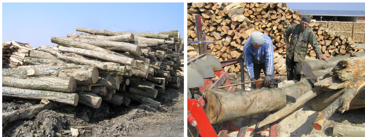
Slika 18. Stovarište višemetrice i njezino prikraćivanje motornom lančanom pilom na metricu
