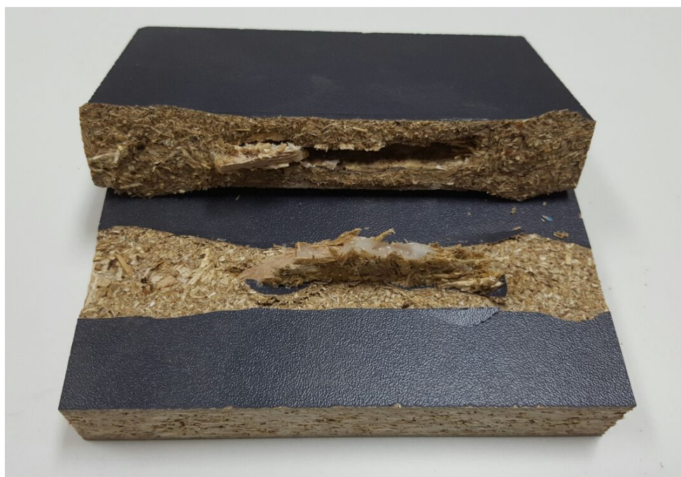
Slika 47. Uzorak L-IT nakon ispitivanja izvlačne čvrstoće
