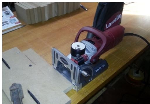
Slika 32. Ručna glodalica Zeta P2
