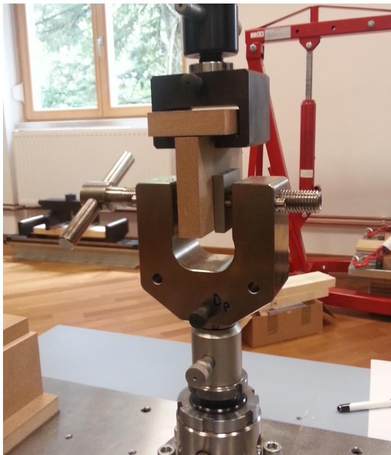
Slika 49. Uzorak T-MDF pri ispitivanju izvlačne čvrstoće
