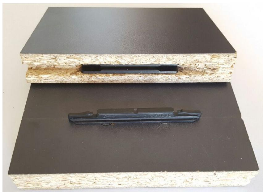
Slika 56. Uzorak D-IT nakon ispitivanja izvlačne čvrstoće
