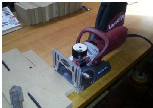
Slika 32. Ručna glodalica Zeta P2
