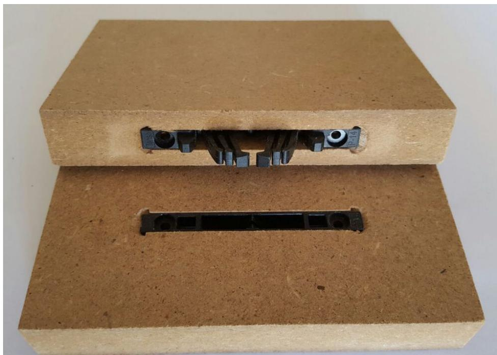
Slika 50. Uzorak T-MDF nakon ispitivanja izvlačne čvrstoće
