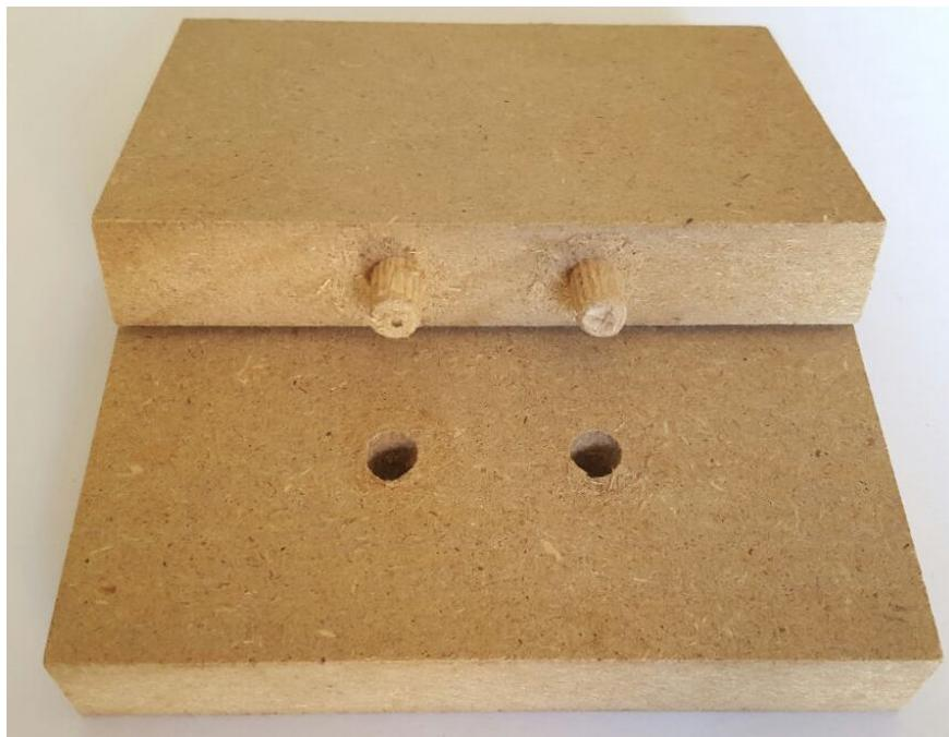
Slika 44. Uzorak M-MDF nakon ispitivanja izvlačne čvrstoće
