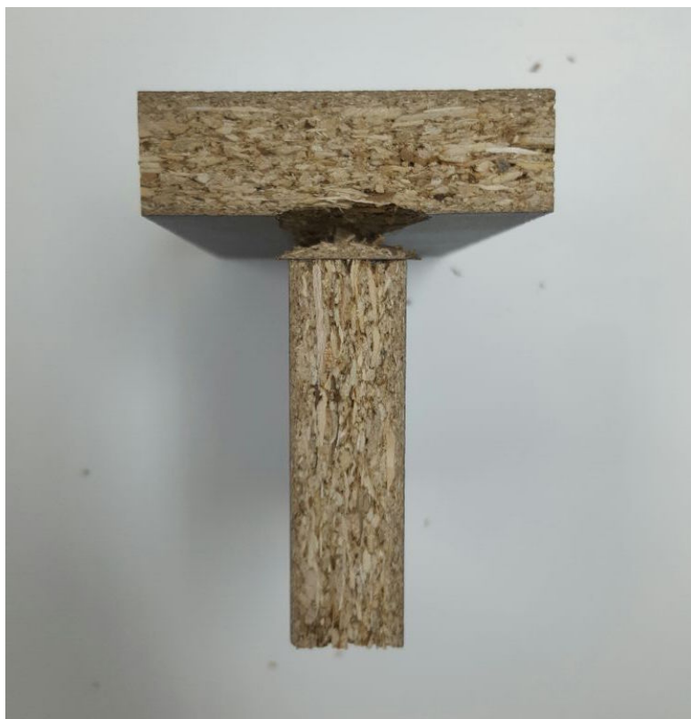
Slika 46. Uzorka L-IT pri ispitivanju izvlačne čvrstoće
