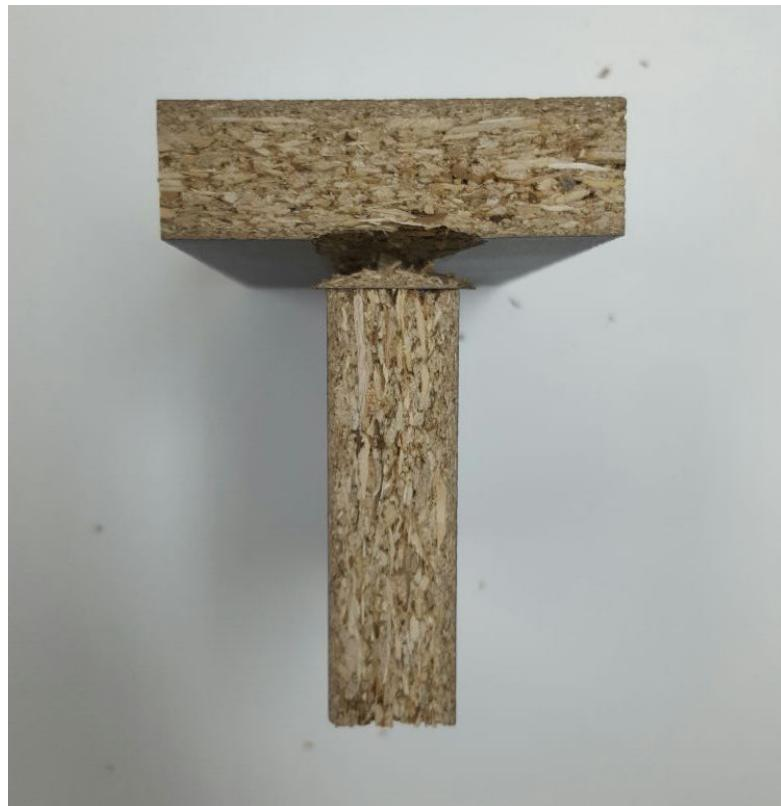
Slika 46. Uzorka L-IT pri ispitivanju izvlačne čvrstoće
