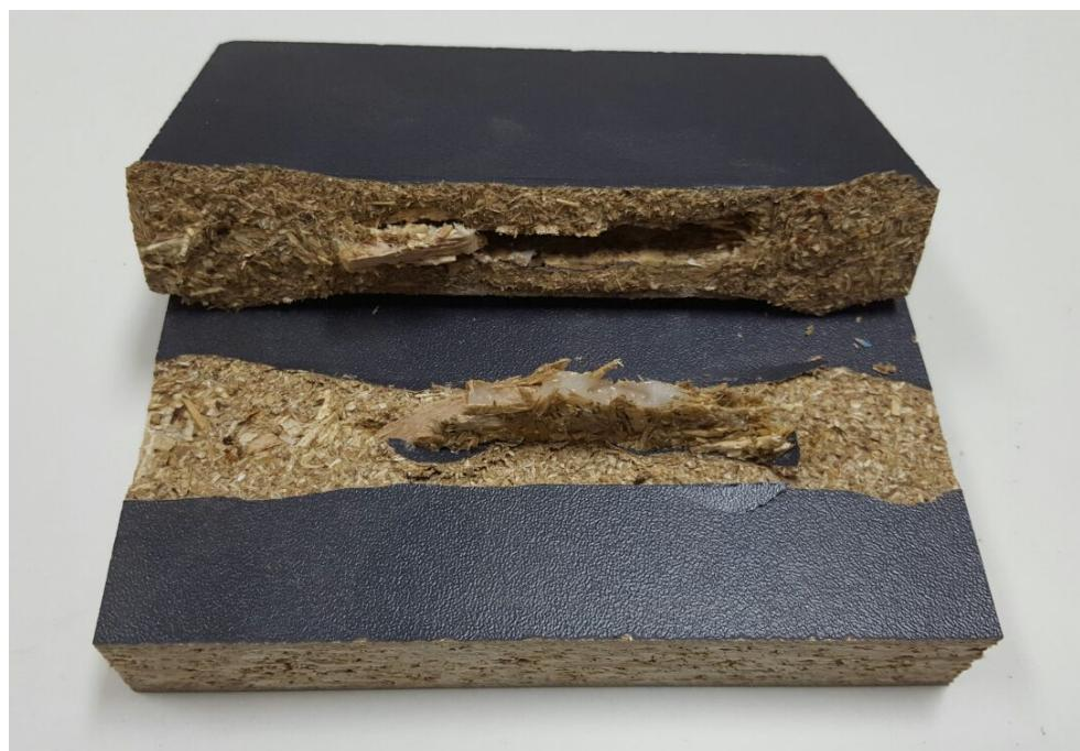
Slika 47. Uzorak L-IT nakon ispitivanja izvlačne čvrstoće
