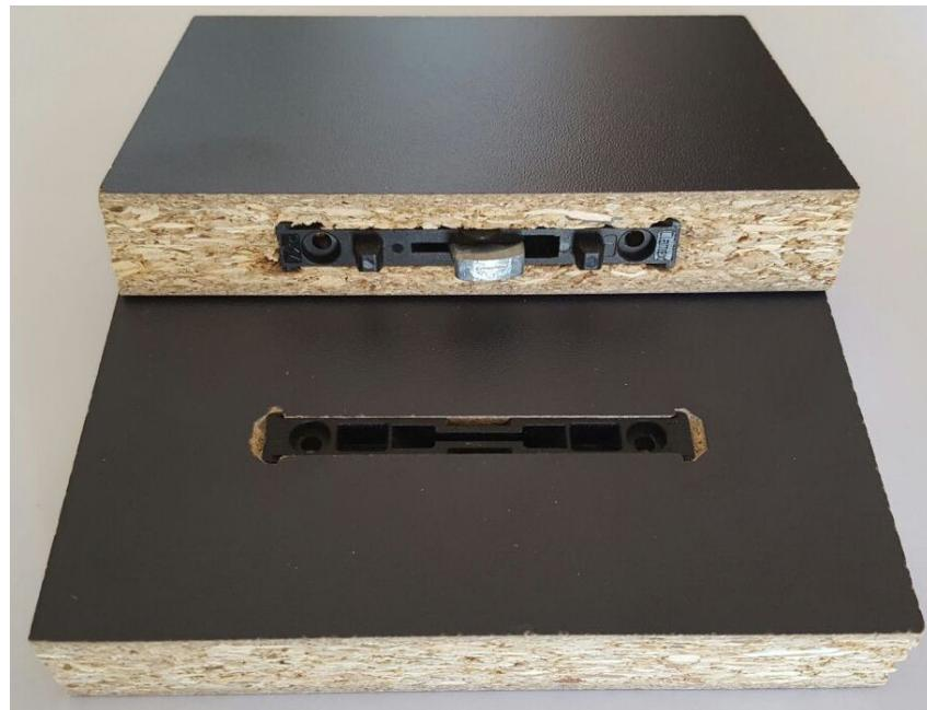
Slika 53. Uzorak C-IT nakon ispitivanja izvlačne čvrstoće
