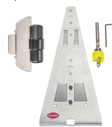
Slika 36. Alata za zacrtavanje i instalaciju "Divario P-18" veznog elementa (fotografija preuzeta s interneta, 2016.) 44
