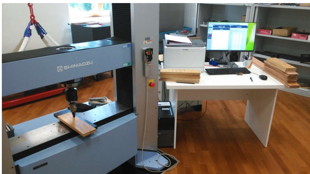
Slika 18 – Prikaz opreme za ispitivanje tvrdoće površine po Brinellu
