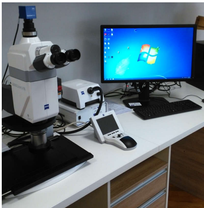
Slika 21 – Prikaz opreme korištene za određivanje dubine penetracije
