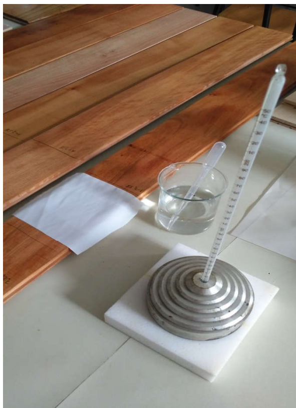
Slika 13 – Prikaz ispitivanja otpornosti površine prema toplini bez vlage
