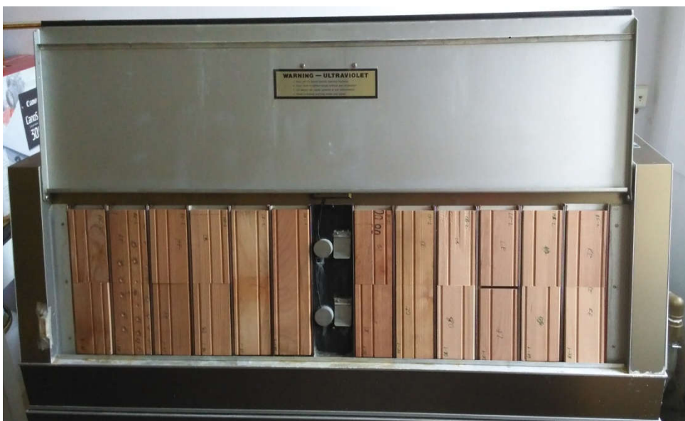
Slika 23 – Prikaz QUV uređaja i načina slaganja uzoraka
