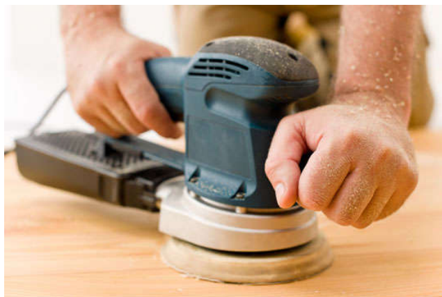
Slika 9 – Prikaz brušenja drva ručnom kružnom brusilicom
