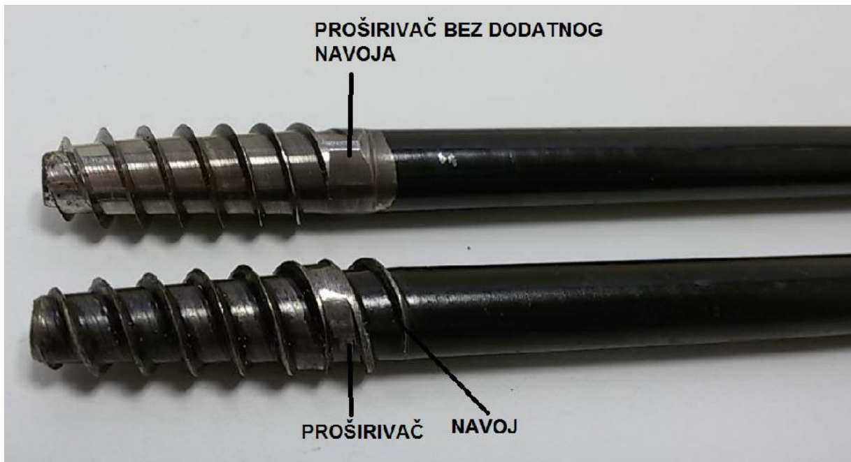
Slika 3.3 Razlika između Presslerovog svrdla proizvođača Suunto (dolje) te Haglof proizvođača (gore)
