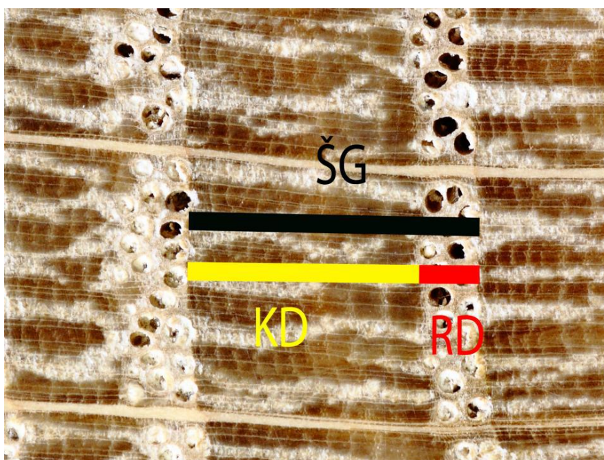
Slika 3.5 Prikaz načina izmjere godova: ŠG – širina goda, RD – širina ranog drva, KD – širina kasnog drva (preuzeto od Goršić, 2013; Doktorski rad)
