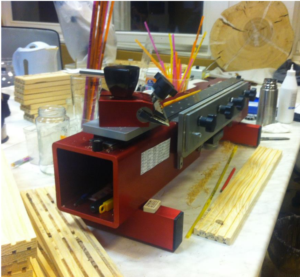
Slika 18. Dendroekološki laboratorij s kliznim mikrotomom (foto: Krešimir Begović)
