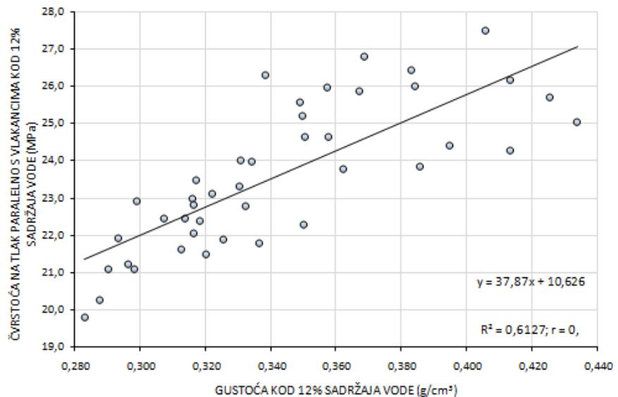
*Slika 11. Graf ovisnosti čvrstoće na tlak paralelno s vlakancima o gustoći klena bijele topole kod 12% sadržaja vode*
