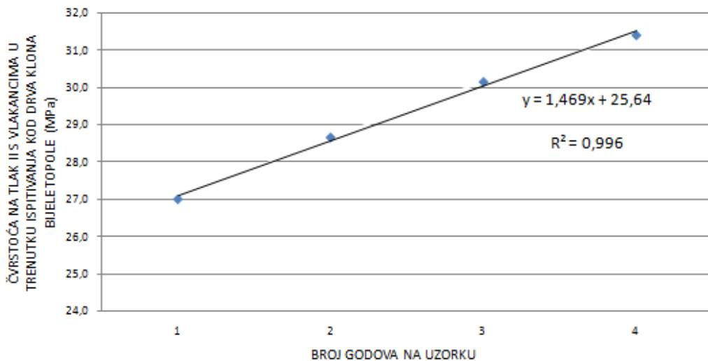
*Slika 15. Graf ovisnosti čvrstoće na tlak paralelno s vlakancima kod drva klena bijele topole o broju godova na uzorku*
