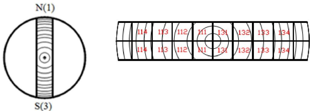
Slika 6. Srednjača (Sjever – Jug) i uzorci dimenzija  $20 \text{ mm} \times 20 \text{ mm} \times 40 \text{ mm}$  iz srednjače
