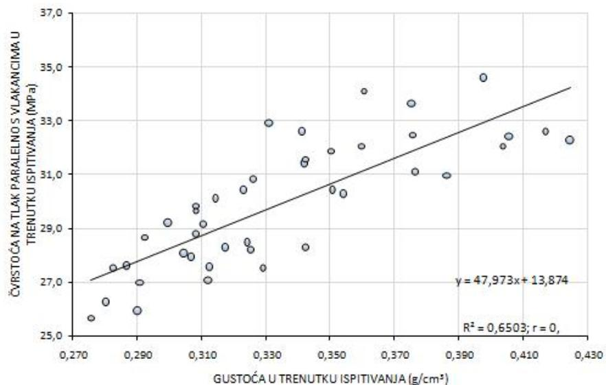
*Slika 12. Graf ovisnosti čvrstoće na tlak paralelno s vlakancima o gustoći klena bijele topole u trenutku ispitivanja*
