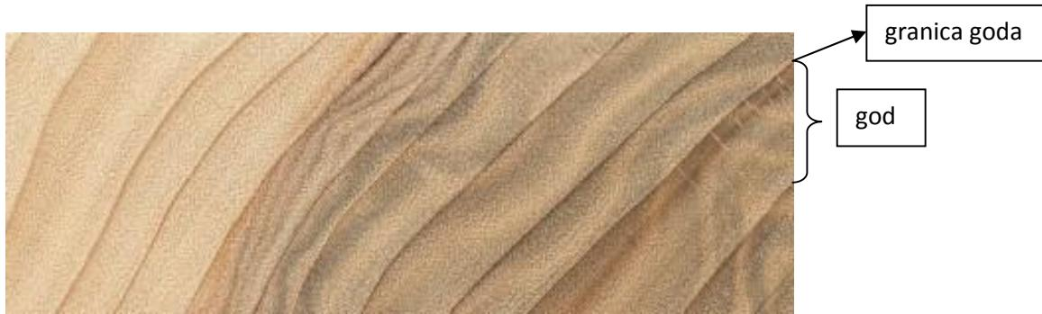
Slika 7. Poprečni presjek drva topole
