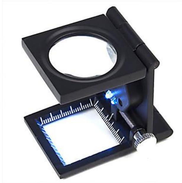
**Slika 4.** Mjerni instrument za određivanje promjera ulupka (lupa)
