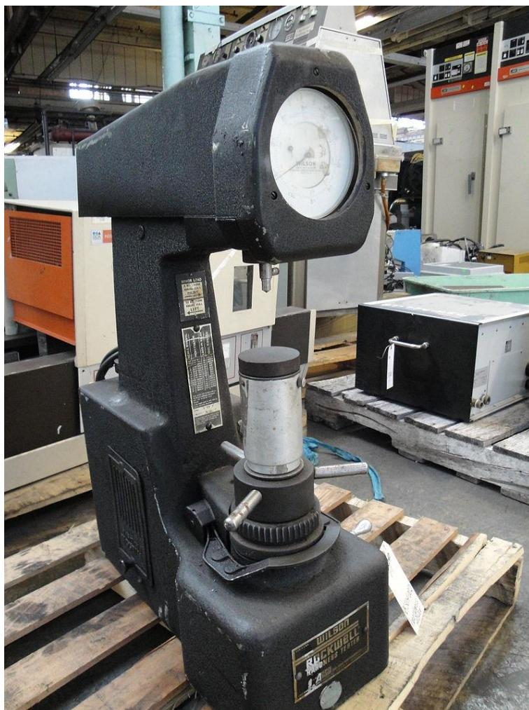
**Slika 7.** Uredaj za određivanje tvrdoće po Rockwellu
