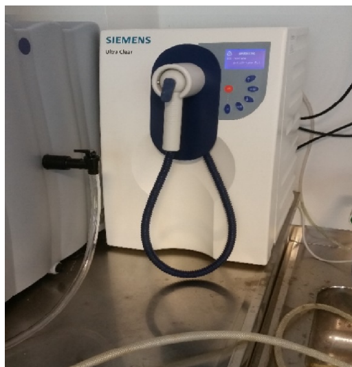
Slika 1. Uređaj za pripravu ultračiste vode Siemens Ultra clear
