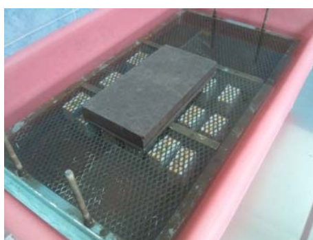
Slika 4. Tretman uzoraka u priručnoj vodenoj kupelji
