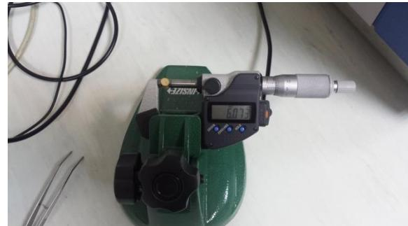
(slika 20.; mikrometar s postoljem)
