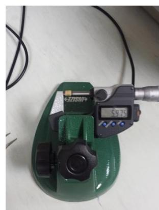
(slika 23.; mjerjenje dimenzija peleta)
