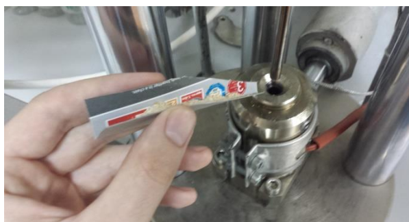
(slika 21.; doziranje pripremljene drvene sirovine u prešu)
