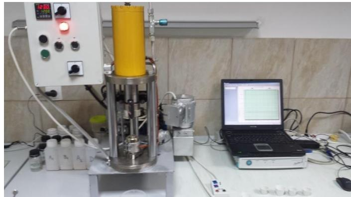
(slika 18.; hidraulična preša i računalo za mjerjenje sile prešanja)
