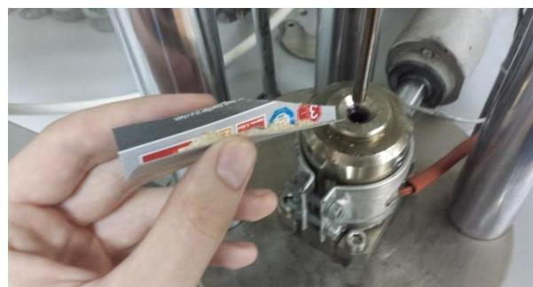
(slika 21.; doziranje pripremljene drvne sirovine u prešu)
