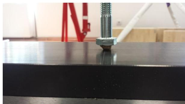
(slika 25.; mjerjenje tlačne čvrstoće pomoću kidalice Shimadzu Autograph AG – X plus)
