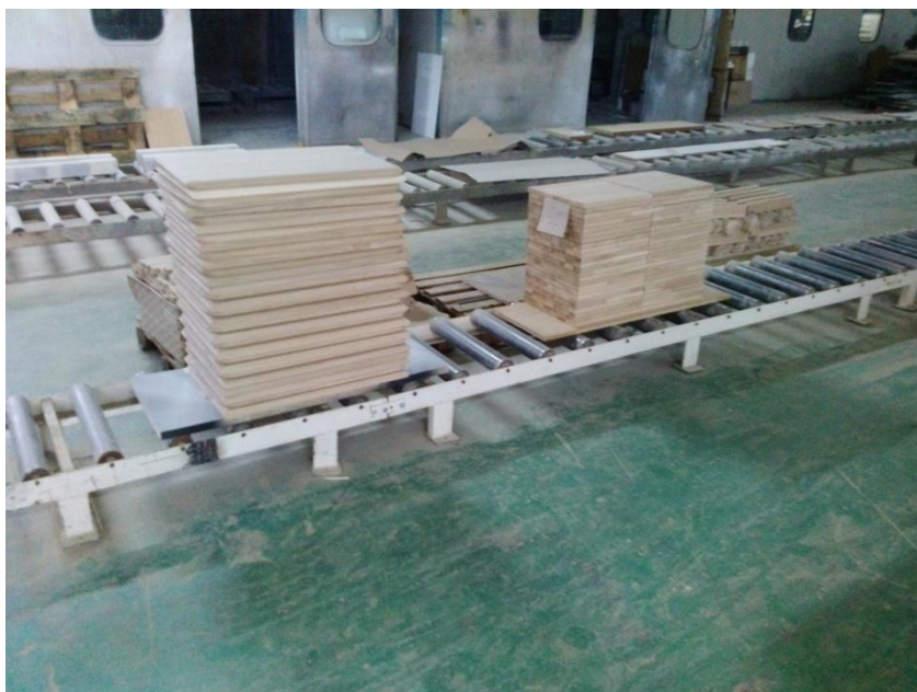
Slika 17. Transport obrađenih elemenata
