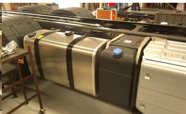
Slika 83. Opremanje kamiona aluminijskim spremnikom za gorivo
