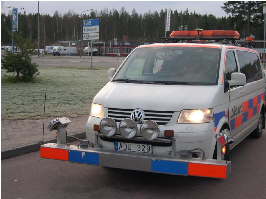
Slika 24. Laserski sustav za snimanje stanja ceste (Izvor: Svenson 2011)
