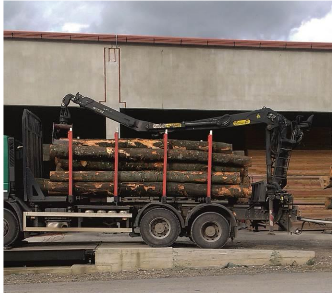
Slika 89. "Ispruženi" položaj dizalice
