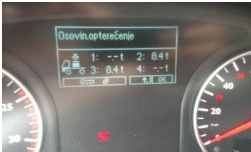
Slika 39. Prikaz izmjerenih osovinskih opterećenja u kabini kamiona
