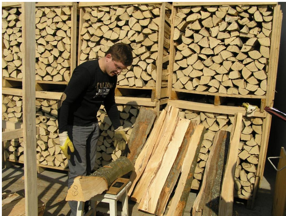
Slika 24. Mjerenje mase cijepanica na digitalnoj vagi
