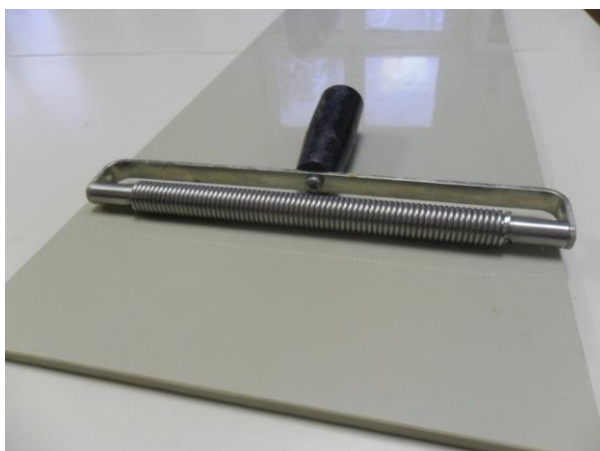
Slika 10. Nanošenje premaza spiralnim aplikatorom na polipropilensku ploču
