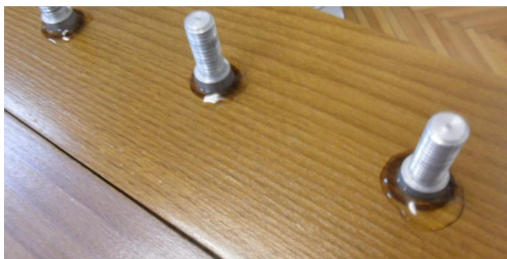
Slika 17. Prikaz zalijepljenog valjčića prilikom određivanja mokre adhezije
