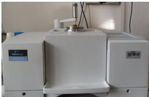
Slika 26. Mjerenje kemijskih promjena uzoraka drva na Perkin Elmer Spectrum One spektrofotometru ATR metodom
