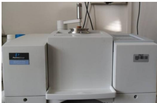
Slika 26. Mjerenje kemijskih promjena uzoraka drva na Perkin Elmer Spectrum One spektrofotometru ATR metodom
